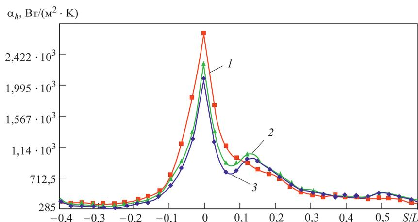
**Рис. 3.** Распределение коэффициентов теплоотдачи на поверхности теплоподвода защитного покрытия для отдельного сечения по высоте пера: 1 — корневое сечение, 2 — среднее сечение, 3 — периферийное сечение
