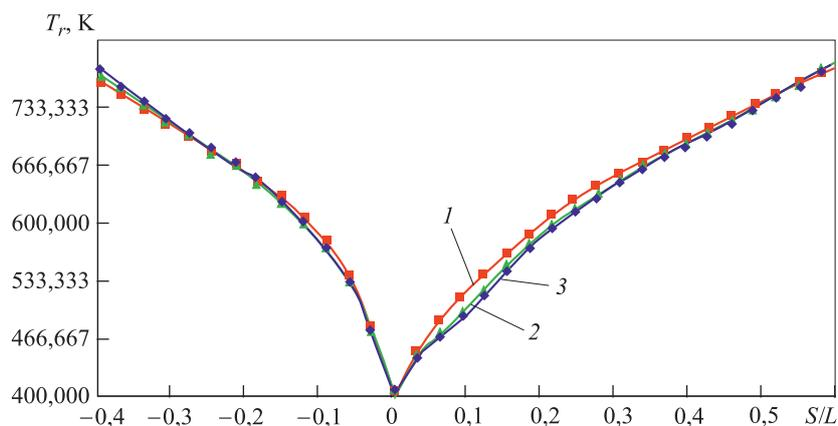
**Рис. 6.** Распределение температуры охлаждающего газа по контуру лопатки для отдельного сечения по высоте пера:
