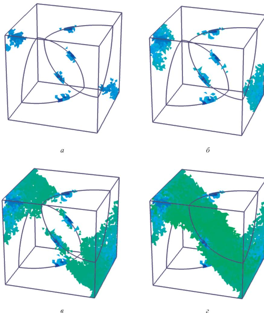
**Рис. 5.** Этапы численного моделирования процесса распространения мезоповреждений в ЯП композита Al + SiC (20 %) с учетом пластичности (а–г)
