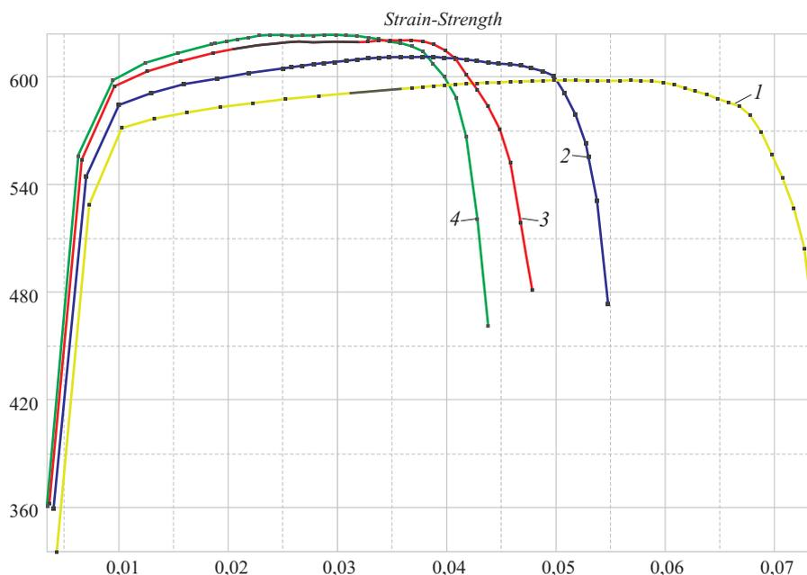
**Рис. 6.** Расчетные эффективные диаграммы деформирования композита Al + SiC с различным содержанием частиц SiC при растяжении:
