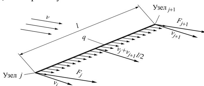
**Рис. 6.** Замена распределенной аэродинамической нагрузки сосредоточенными узловыми силами
