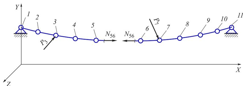
**Рис. 1.** Дискретная модель абсолютно гибкого стержня (цифрами показаны узловыe точки)
