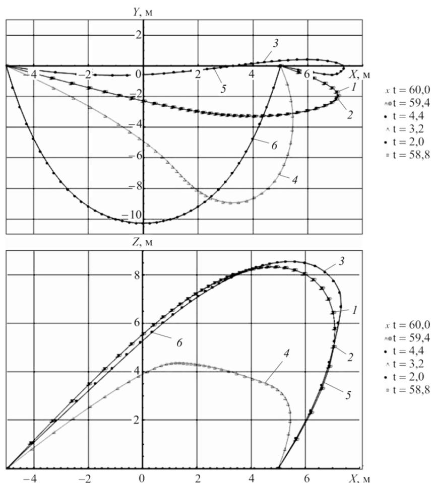
**Рис. 7.** Положение кабеля под действием ветровой нагрузки в плоскости  $XU$  (вверху) и  $XZ$  (внизу) при  $C = 0,41$ :
