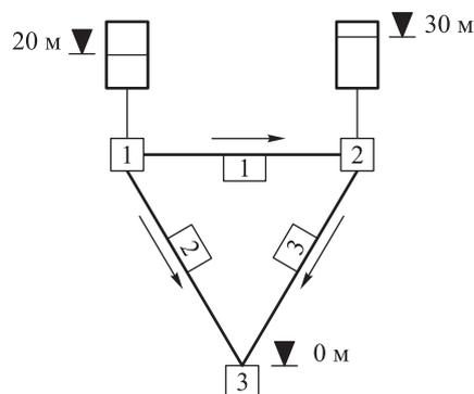
Рис. 1. Простая гидравлическая сеть
