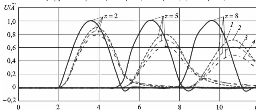
**Рис. 2.** Зависимости перемещения от времени в фиксированных ( $z = 2, 5, 8$ ) сечениях вязкоупругого стержня со слабосингулярным ядром ( $A = 0,1$ ;  $\alpha = 1$ ) при различных значениях параметра  $\beta$ :
