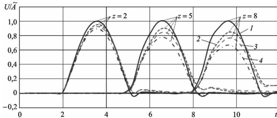
**Рис. 1.** Зависимости перемещения от времени в фиксированных ( $z = 2, 5, 8$ ) сечениях вязкоупругого стержня с экспоненциальным ядром ( $A = 0,1$ ;  $\alpha = 1$ ) при различных значениях параметра  $\beta$ :
