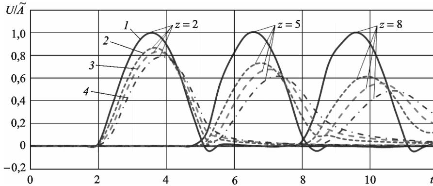
**Рис. 3.** Зависимости перемещения от времени в фиксированных ( $z = 2, 5, 8$ ) сечениях вязкоупругого стержня со слабосингулярным ядром ( $A=0,1; \beta = 0,1$ ) для различных значений параметра  $\alpha$  :
