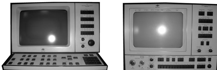
Рис. 5. Анализаторы сигналов 2131 и 2034 фирмы «Брюль и Кьер»
