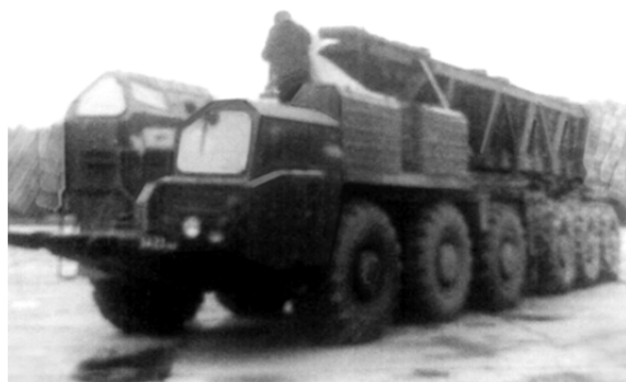
Рис. 1. Шасси МА3-547В на испытательной трассе
