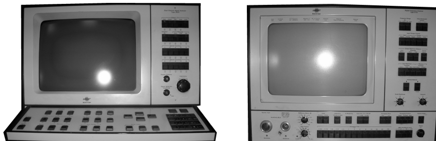
Рис. 5. Анализаторы сигналов 2131 и 2034 фирмы «Брюль и Кьер»
