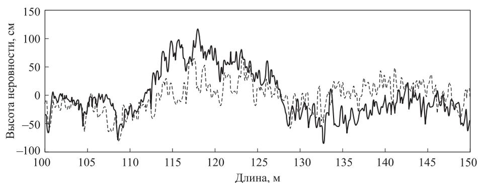
**Рис. 3.** Реализация профиля по двум колесам булыжной дороги:
