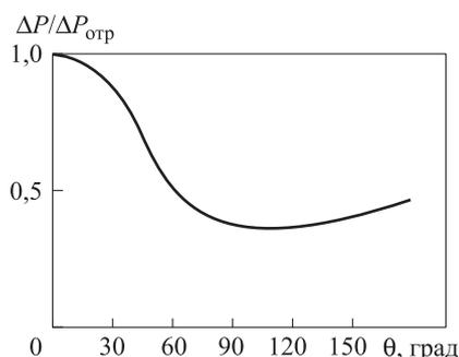
**Рис. 7.** Изменение максимального давления по периметру оболочки
