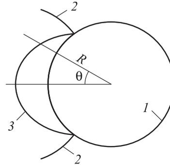
**Рис. 2.** Схема взаимодействия ударной волны с оболочкой:
