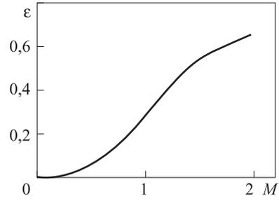
Рис. 8. Зависимость поправочного коэффициента от числа Маха
