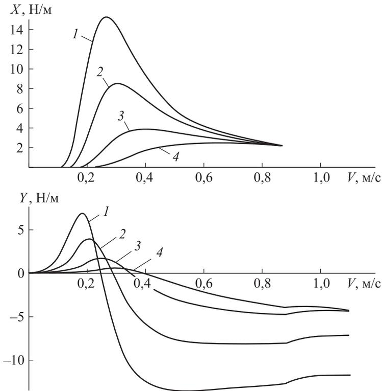
**Рис. 4.** Графики  $X(V)$  и  $Y(V)$ , приведенные по результатам безвихревой модели авторов [6] (кривые соответствуют локализации диполя под слоем скачка плотности на расстояниях  $h_i = 1,5; 2; 3; 4,5$  м от невозмущенного его положения)
