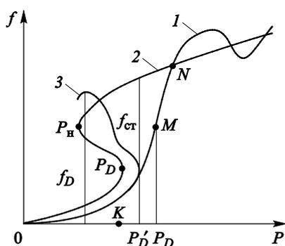
**Рис. 1.** Диаграмма «стрела прогиба – нагрузка» для цилиндрической оболочки:
