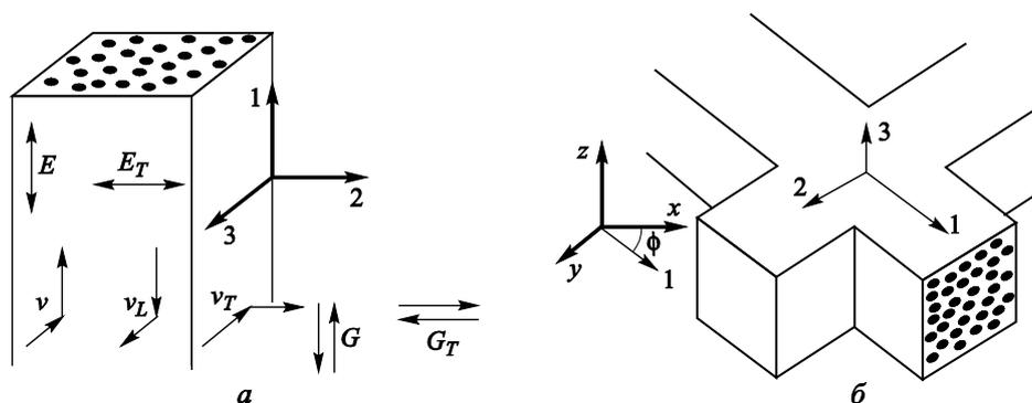
**Рис. 1.** Ортотропное ребро из углепластика:
