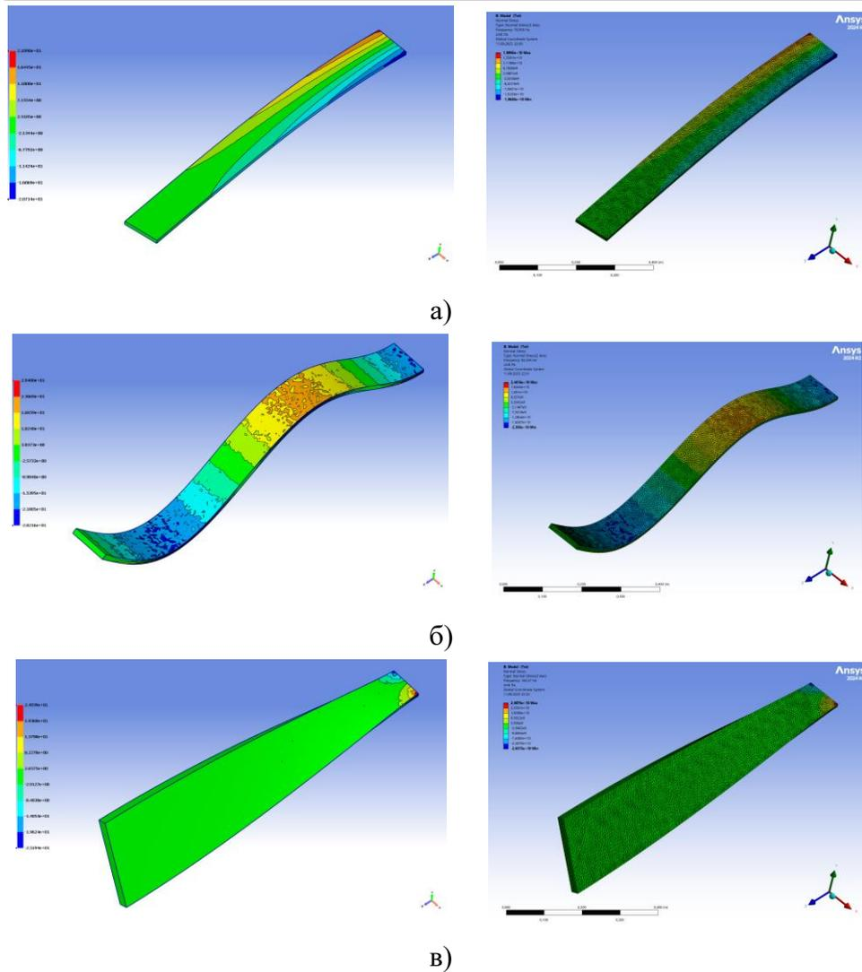
**Рис. 3.** Сравнение компоненты  $\sigma_{33}$  тензора напряжений, полученной в ПК «Manipula»/SMCM (слева) и ПК ANSYS (справа):
