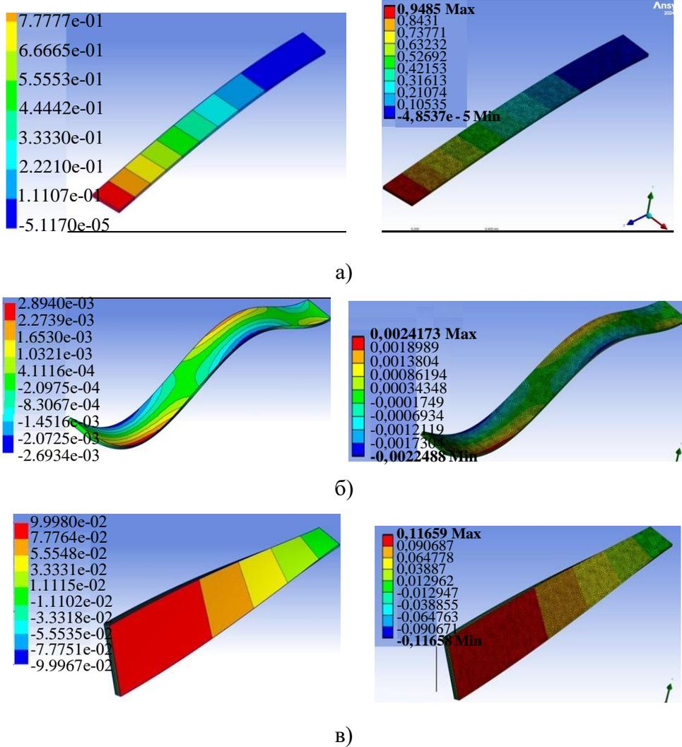
Рис. 2. Сравнение компоненты  $w_1$  вектора перемещений, полученной в ПК «Manipula»/SMCM (слева) и ПК ANSYS (справа):
