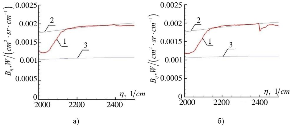
**Рис. 3.** Функция Планка в слое газа  $\text{CO}_2$  в области 4.3 мкм. Анализ воздействия неравновесности по температуре деформационной колебательной моды.  $T_{v_1} = T_{v_2} = 1250\text{ К}$ ,  $T = T_{v_3} = T_r = 1550\text{ К}$ .
