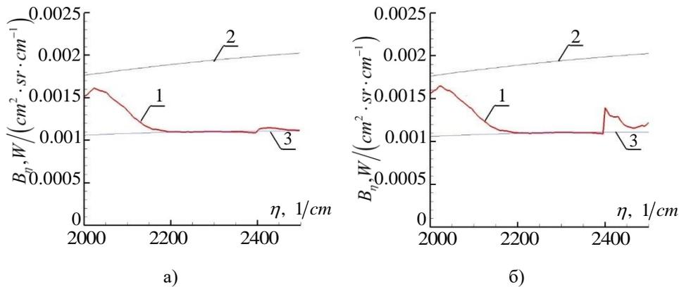
**Рис. 6.** Функция Планка в слое газа  $\text{CO}_2$  в области 4.3 мкм. Анализ воздействия неравновесности по температуре асимметричной колебательной моды.  $T_{v_1} = T_{v_2} = 1250\text{K} , T = T_{v_3} = T_r = 1550\text{K} .$
