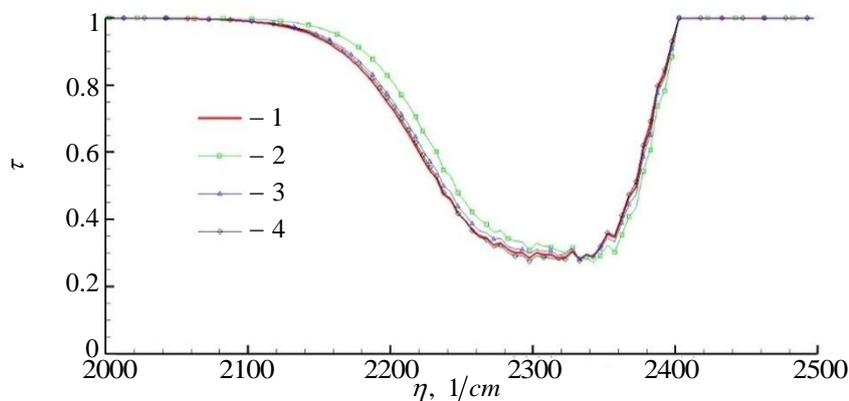
Рис. 7. Пропускательная способность слоя газа  $CO_2$  в области 4.3 мкм.
