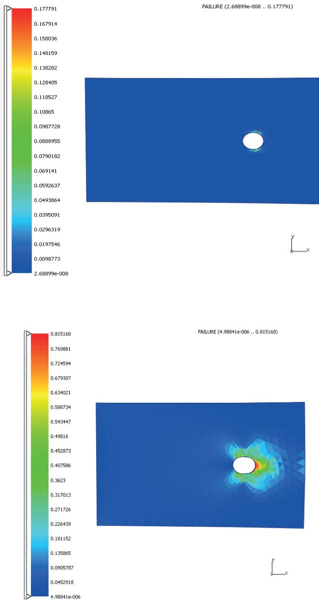
**Рис. 6.** Поле параметра повреждаемости материала в пластине при двух значениях растягивающего перемещения  $U(t)$
