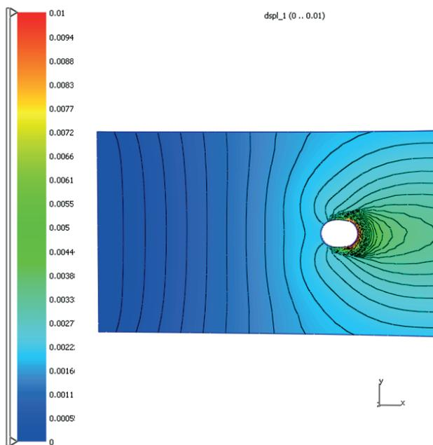
**Рис. 5.** Поля поперечного нормального напряжения  $\sigma_{22}$ , МПа, и продольного перемещения  $u_1$ , м, в пластине в задаче овализации
