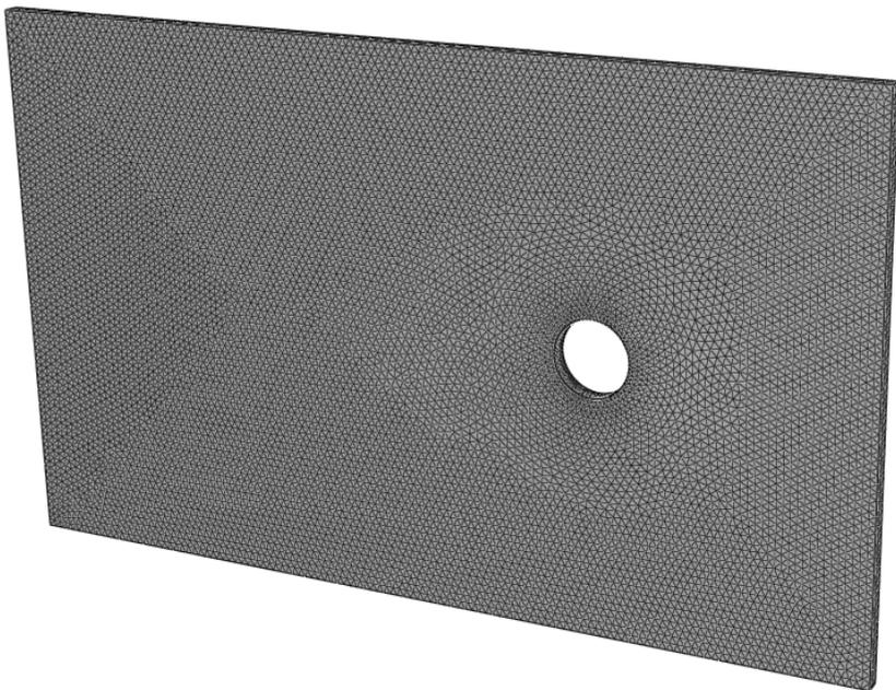
Рис. 3. Конечно-элементная сетка, построенная для решения задачи овализации
