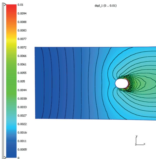
**Рис. 5.** Поля поперечного нормального напряжения  $\sigma_{22}$ , МПа, и продольного перемещения  $u_1$ , м, в пластине в задаче овализации
