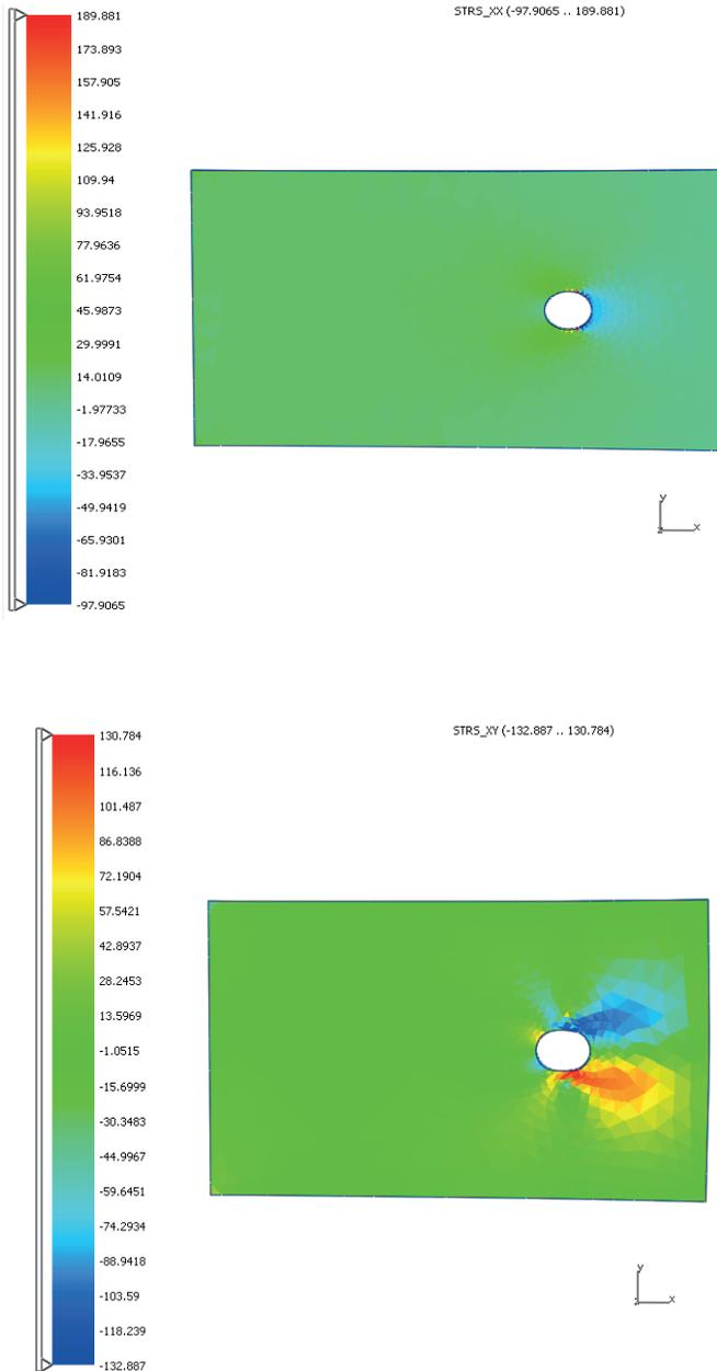
Рис. 4. Поля напряжений  $\sigma_{11}$  и  $\sigma_{12}$ , МПа, в пластине в задаче овализации
