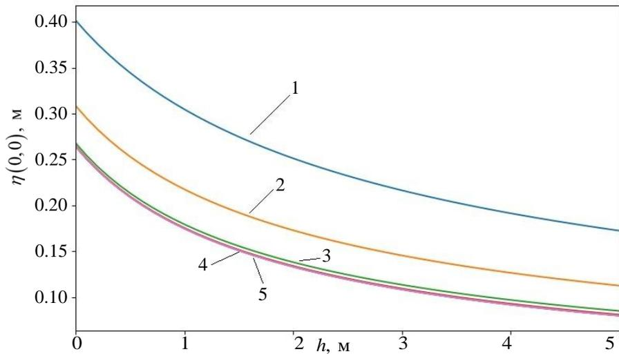
**Рис. 6.** Зависимость максимального отклонения точки поверхности льда  $\eta(0,0)$  (м) от толщины льда  $h$  (м) при различных глубинах жидкости:
