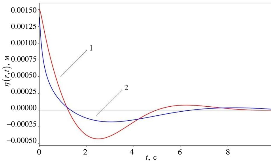
**Рис. 3.** Зависимость отклонения точки поверхности льда, находящейся непосредственно над источником ( $r=0$  м) от времени  $t$  (с) при различных параметрах: 1 —  $h=0,25$  м;  $L=570$  м; 2 —  $h=0,7$  м;  $L=230$  м
