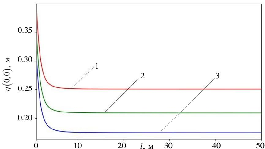
**Рис. 8.** Зависимость максимального отклонения точки поверхности льда  $\eta(0,0)$  (м) от глубины дна  $L$  (м) при различных толщинах льда:
