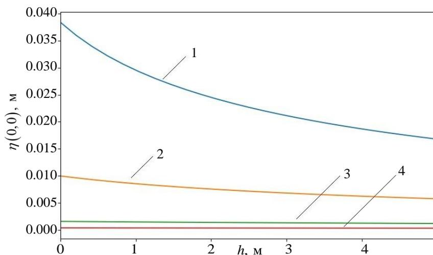
**Рис. 5.** Зависимость максимального отклонения точки поверхности льда  $\eta(0,0)$  (м) от толщины льда  $h$  (м) при  $L=100$  м и различных глубинах источника: 1 —  $l=5$  м; 2 —  $l=10$  м; 3 —  $l=25$  м; 4 —  $l=50$  м
