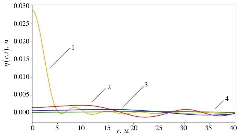
**Рис. 1.** Профили волн на ледяном покрове в различные моменты времени (мелкая вода)  $t$  (с): 1 —  $t=0$  с; 2 —  $t=0,1$  с; 3 —  $t=0,3$  с; 4 —  $t=1$  с
