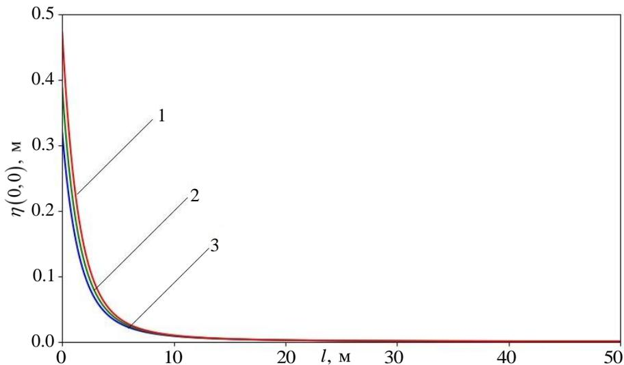
**Рис. 7.** Зависимость максимального отклонения точки поверхности льда  $\eta(0,0)$  (м) от глубины источника  $l$  (м) при различных толщинах льда:
