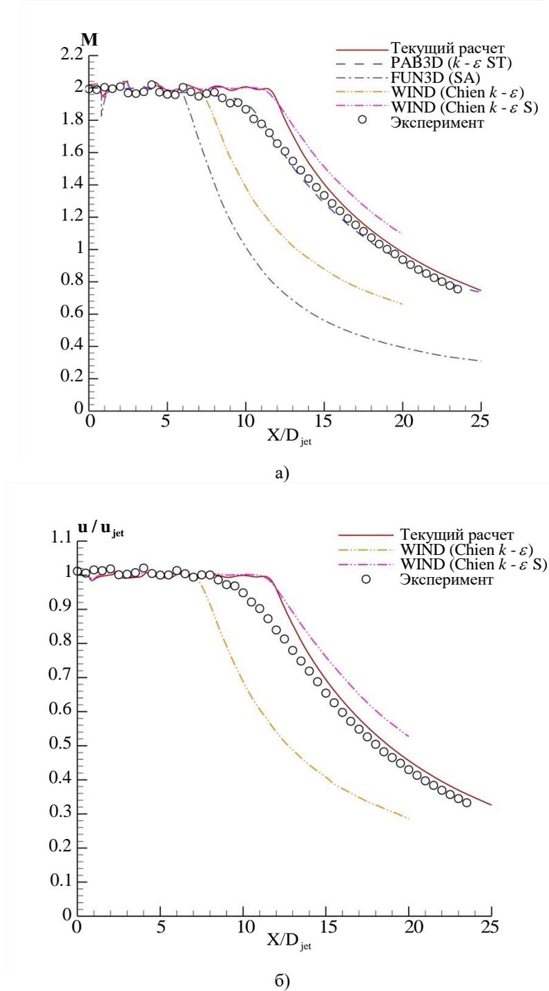
Рис. 7. Распределения безразмерных параметров вдоль оси струи: а) — число Маха; б) — продольная компонента скорости
