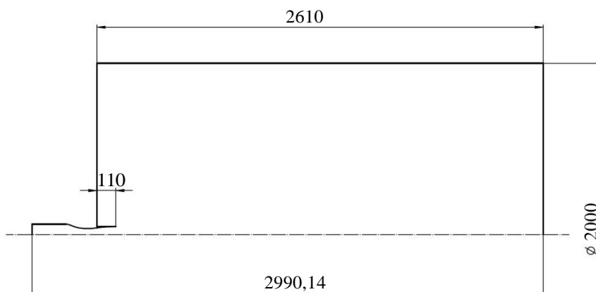
Рис. 2. Габаритные размеры (мм) осесимметричной расчетной области
