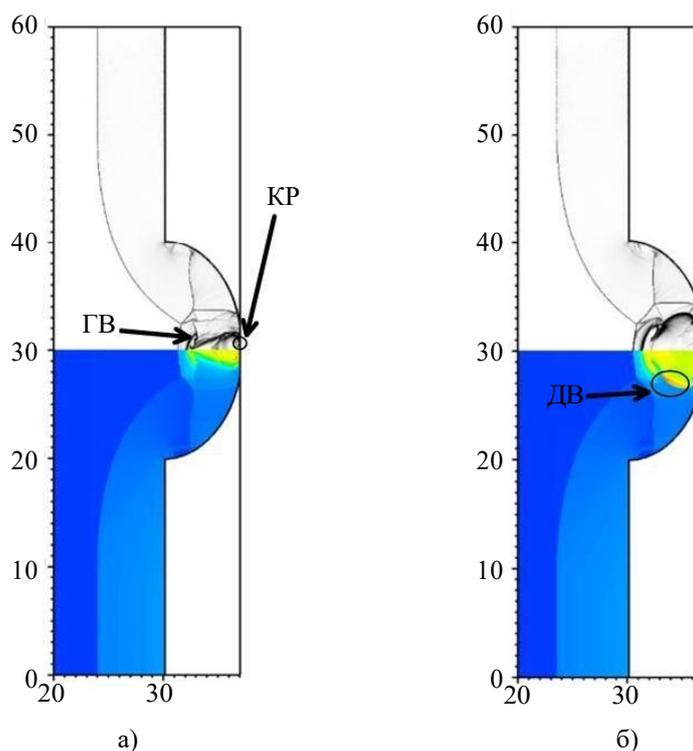
**Рис. 4.** Численные срезы визуализации (сверху) и распределения температуры (снизу) в последовательные моменты времени для случая одностадийной кинетики и числа Маха начальной УВ 2.6: а) — 16 мкс, б) — 16.5 мкс. Температурная шкала совпадает со шкалой рис. 3. Длины указаны в миллиметрах
