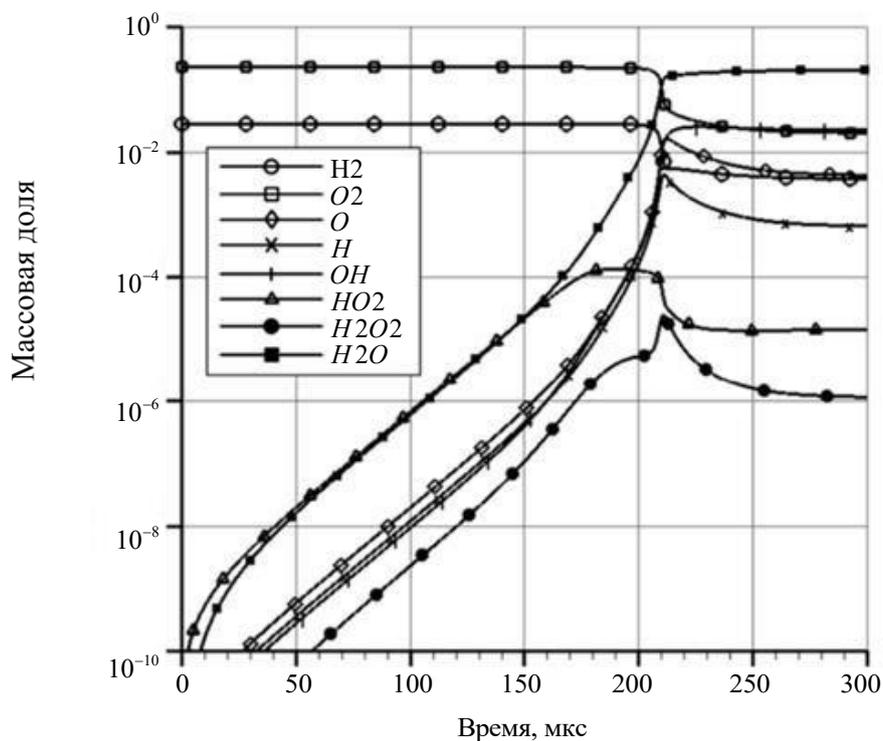
Рис. 2. Зависимость массовых долей компонент водородно-воздушной смеси от времени при начальном давлении 1 атм и температуре 1000 К
