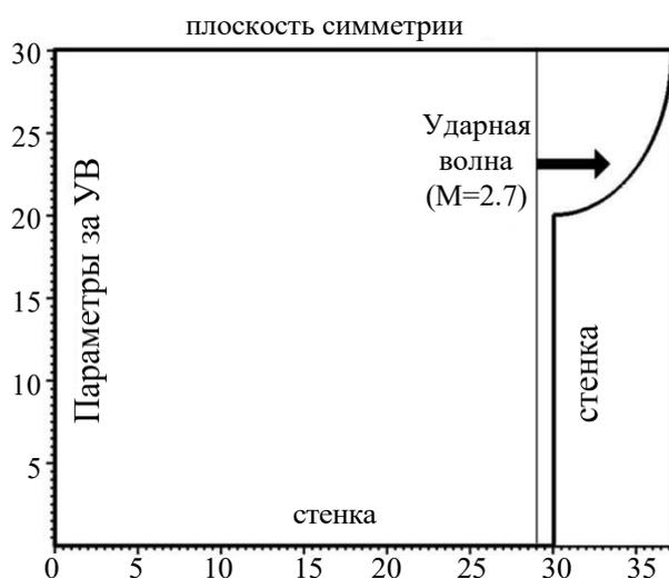
Рис. 1. Схема расчетной области. Все размеры в миллиметрах
