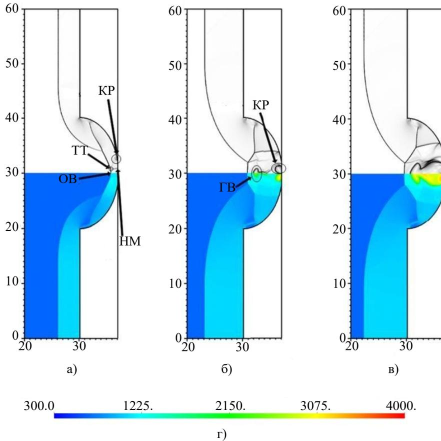
**Рис. 3.** Численные шпирен визуализации (сверху) и распределения температуры (снизу) в последовательные моменты времени для случая детальной кинетики и числа Маха начальной УВ 2.7: а) — 8.5 мкс, б) — 14 мкс, в) — 15.5 мкс, г) — температурная шкала в градусах Кельвина. Длины указаны в миллиметрах
