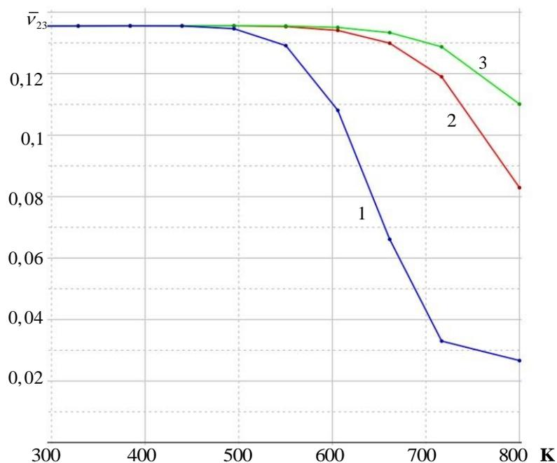
**Рис. 8.** Изменение эффективного коэффициента Пуассона  $\bar{v}_{23}$  тканевого стеклокомпозита в зависимости от температуры нагрева, при разных скоростях нагрева: 1 – 0,8 град/с; 2 – 1,6 град/с; 3 – 4 град/с
