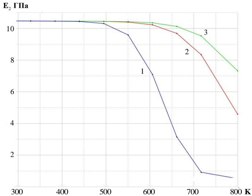
**Рис. 5.** Изменение эффективного по основе модуля упругости  $\bar{E}_2$  тканевого стеклокомпозита в зависимости от температуры нагрева и разных скоростей нагрева: 1 – 0,8 град/с; 2 – 1,6 град/с; 3 – 4 град/с
