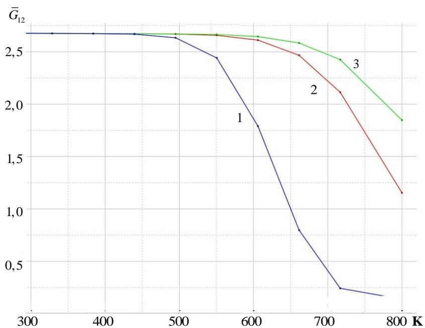
**Рис. 9.** Изменение эффективного модуля сдвига  $\bar{G}_{12}$  тканевого стеклокомпозита в зависимости от температуры нагрева, при разных скоростях нагрева: 1 – 0,8 град/с; 2 – 1,6 град/с; 3 – 4 град/с
