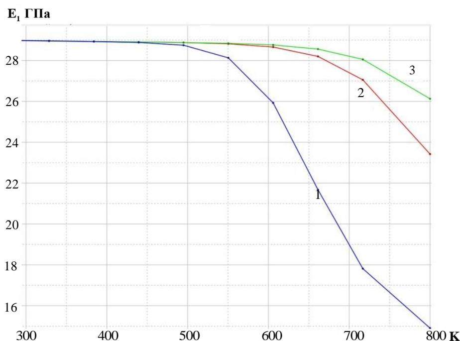
**Рис. 4.** Изменение эффективного модуля упругости  $\bar{E}_1$  по основе тканевого стеклокомпозита в зависимости от температуры нагрева и разных скоростей нагрева: 1 – 0,8 град/с; 2 – 1,6 град/с; 3 – 4 град/с
