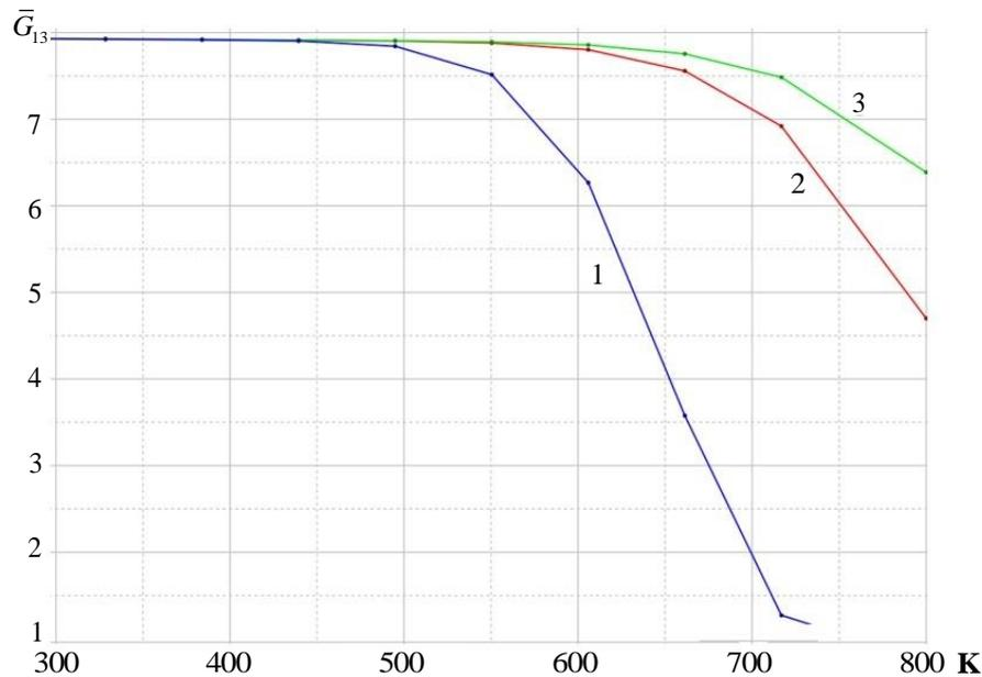
**Рис. 10.** Изменение эффективного модуля сдвига  $\bar{G}_{12}$  тканевого стеклокомпозита в зависимости от температуры нагрева, при разных скоростях нагрева: 1 – 0,8 град/с; 2 – 1,6 град/с; 3 – 4 град/с
