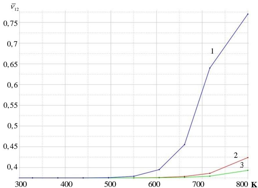
**Рис. 6.** Изменение эффективного коэффициента Пуассона  $\bar{\nu}_{12}$  тканевого стеклокомпозита в зависимости от температуры нагрева и скорости нагрева: 1 – 0,8 град/с; 2 – 1,6 град/с; 3 – 4 град/с
