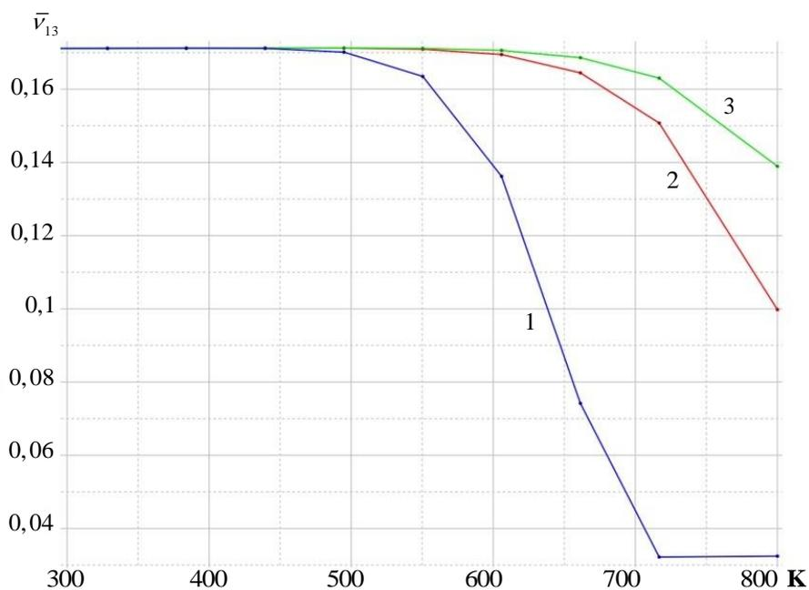
**Рис. 7.** Изменение эффективного коэффициента Пуассона  $\bar{\nu}_{13}$  тканевого стеклокомпозита в зависимости от температуры нагрева и скорости нагрева: 1 – 0,8 град/с; 2 – 1,6 град/с; 3 – 4 град/с
