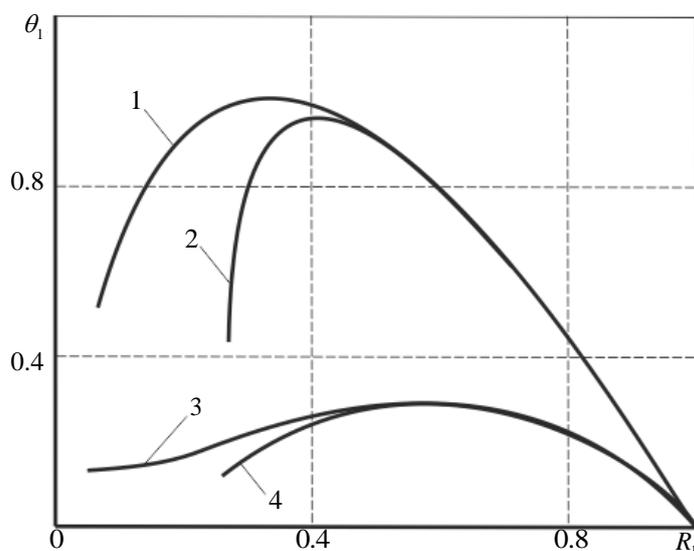
**Рис. 3.** График зависимости безразмерной температуры поверхности от радиуса при отсутствии (кривые 1, 3) и наличии газа в поре (кривые 2, 4) и различных значениях числа Прандтля  $Pr$ : 1,  $2 \cdot 10^4$ , 3,  $4 \cdot 10^3$
