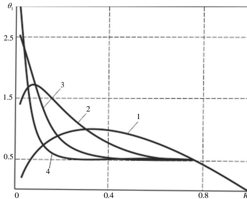
**Рис. 1.** Графики зависимости безразмерной температуры поверхности от радиуса при отсутствии (кривая 1) и при наличии расплавленной зоны в ее окрестности (кривые 2-4), отсутствии газа в порах и различных значениях параметра  $\zeta$ :  $2 \cdot 10^{-1}$ ,  $3 \cdot 10^{-2}$ ,  $4 \cdot 10^{-3}$
