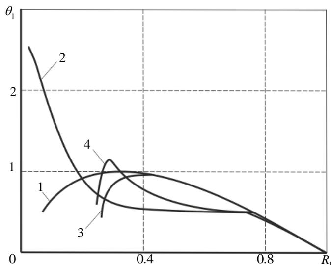
**Рис. 4.** График зависимости безразмерной температуры поверхности поры от радиуса при отсутствии (кривая 1) и наличии расплавленной зоны в ее окрестности  $\pi_{g0}$ : 1, 2–0, 3,  $4 \cdot 10^{-2}$
