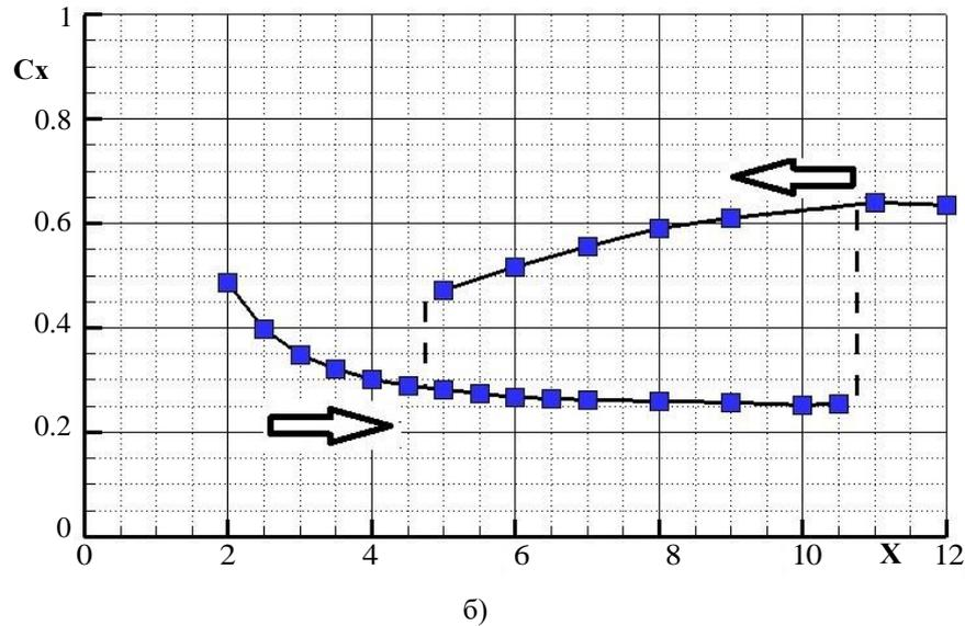
Рис. 8. Коэффициент сопротивления  $C_x$  сферы (1) и диска (2) от  $X$  (а) и системы «сфера+тор» в целом (б)
