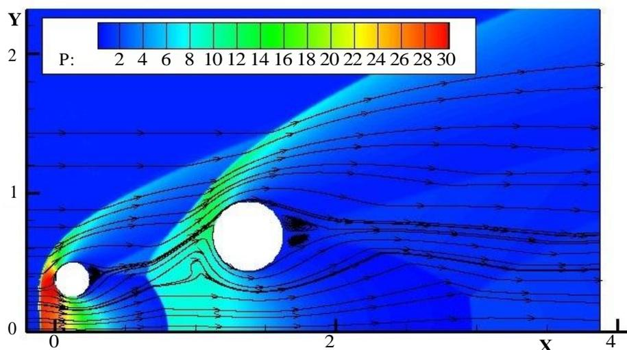
Рис. 12. Течение без отрывной зоной между телами,  $X = 1.375$
