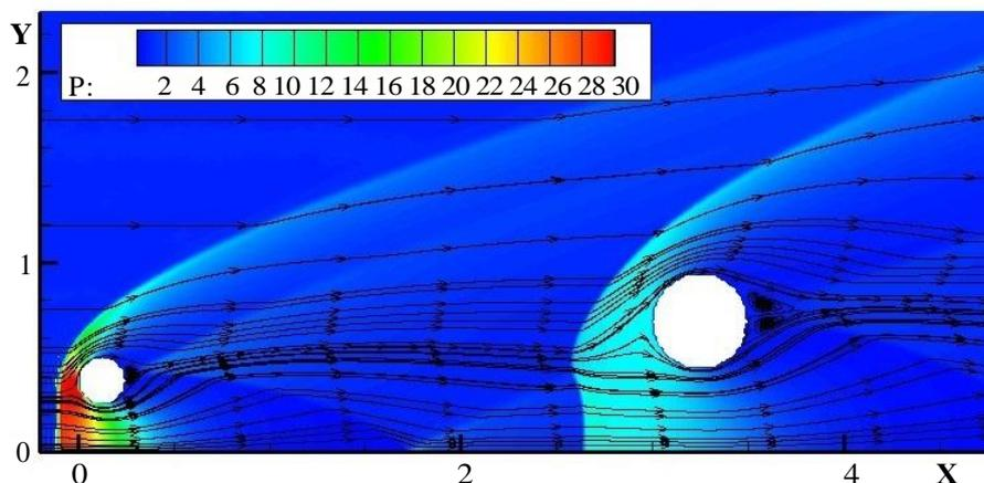
Рис. 14. Течение без циркуляционной зоны перед задней расположенным тором,  $X = 3.25$
