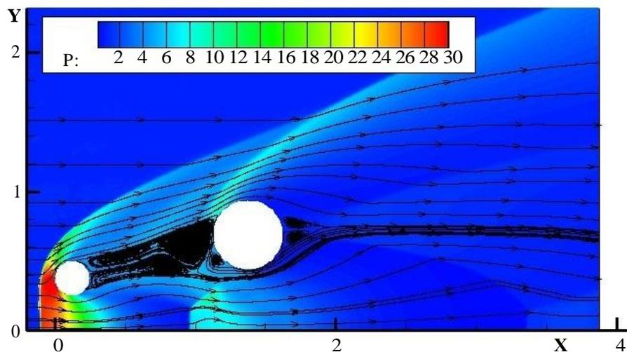
Рис. 11. Течение с отрывной зоной между телами,  $X = 1.375$
