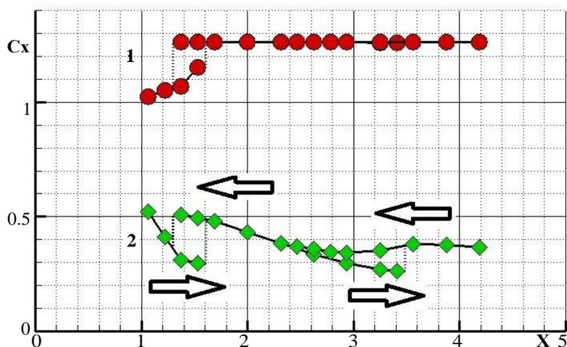
**Рис. 10.** Коэффициент сопротивления  $C_x$  впереди расположенного (1) и сзади расположенного (2) торов от расстояния между ними  $X$
