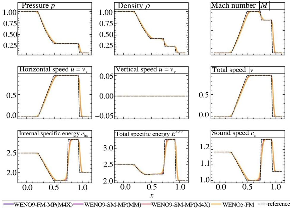
**Рис. 2.** Профили решения теста Сода вдоль  $y = 0.5$  для потока ЛФ, интегрированного SSP RK(10, 4) при CFL=1, с реконструкциями WENO9-SM MP (MM) (фиолетовый цвет), WENO9-SM MP(M4X) (розовый цвет) и WENO5-FM (оранжевый цвет) на  $51 \times 51$  точках. Точное решение проведено пунктиром
