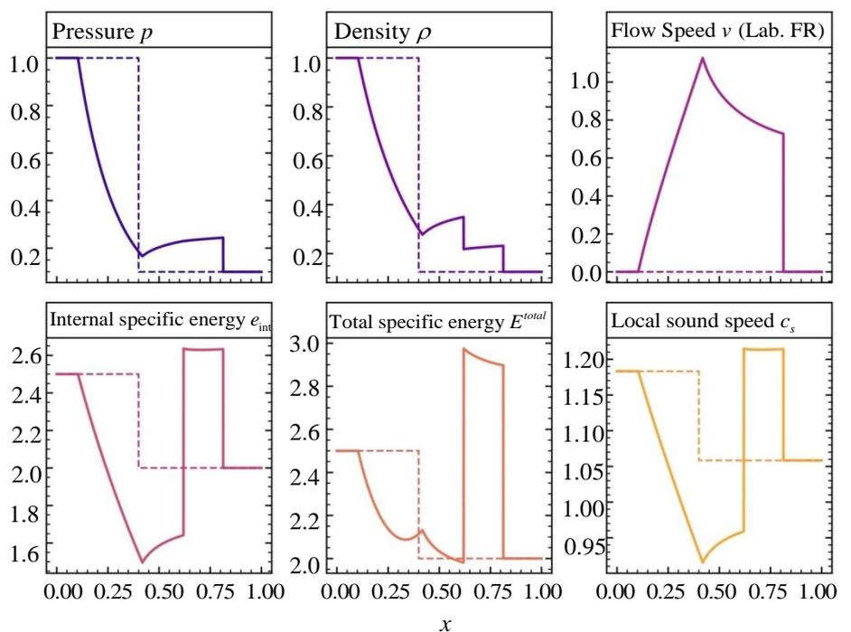
**Рис. 4.** Радиальные профили решения задачи о взрыве Торо, полученные с помощью 1D ЛФ с реконструкцией WENO5-FM, интегрированным SSP RK(10, 4) с  $CFL = 2$  на 20001 точке (пунктиром проведены профили в начальный момент времени), которые берутся нами за эталон
