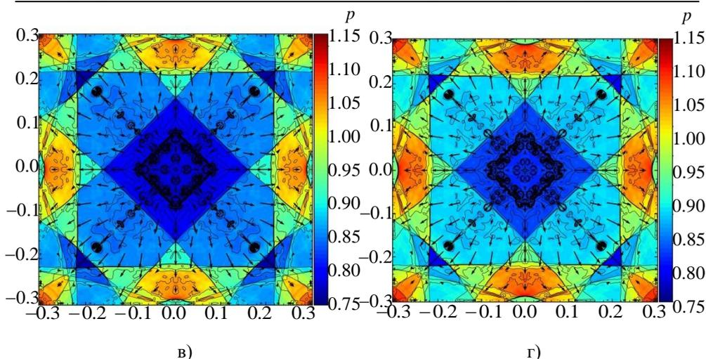
**Рис. 9.** Решения теста имплозии Хуэя и др. [18] имплозии в камере  $[-0.3..0.3] \times [-0.3..0.3]$  ( $801 \times 801$  пространственная сетка) с 12 контурами плотности от 0.45 до 1.05, отображением плотности цветом и поля скоростей стрелками для реконструкций WENO5-FM (а), WENO9-FM MP (б), WENO9-S MP (в), WENO9-SM MP (г). Цвет и контуры взяты такие же, как в работах [14] и [18]
