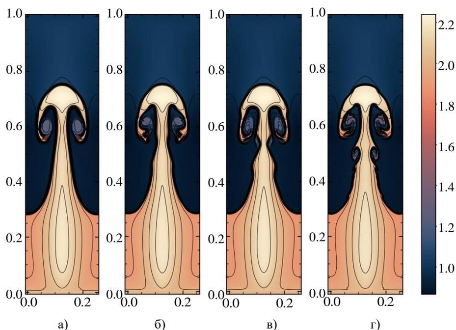
**Рис. 10.** Разрешение поля плотностей теста с неустойчивостью Рэля — Тейлора схемами с расщеплённым потоком ЛФ, интегрированием во времени SSP РК(10, 4) и реконструкциями WENO5-FM (а), WENO9-S MP (б), WENO9-SM MP (в), WENO9-FM MP (г)
