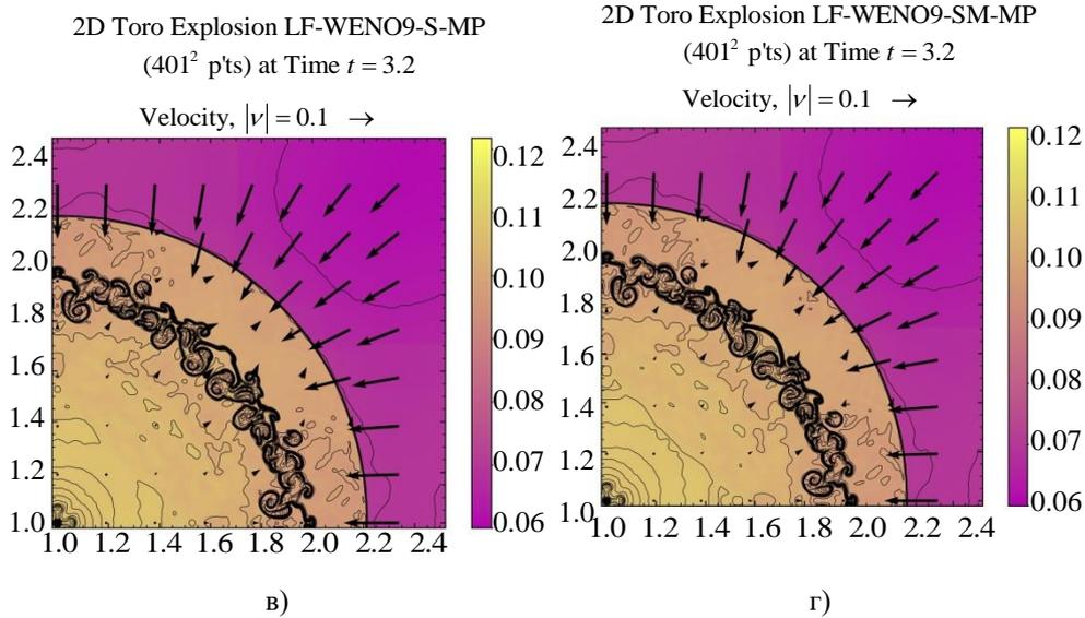
**Рис. 6.** Развитие неустойчивости в решении теста взрыва Торо на большом конечном времени  $t = 3.2$  с 27 контурами плотности от 0.08 до 0.21 для реконструкции WENO5-FM (а), WENO9-FM MP (б), WENO9-S MP (в), WENO9-SM MP (г)
