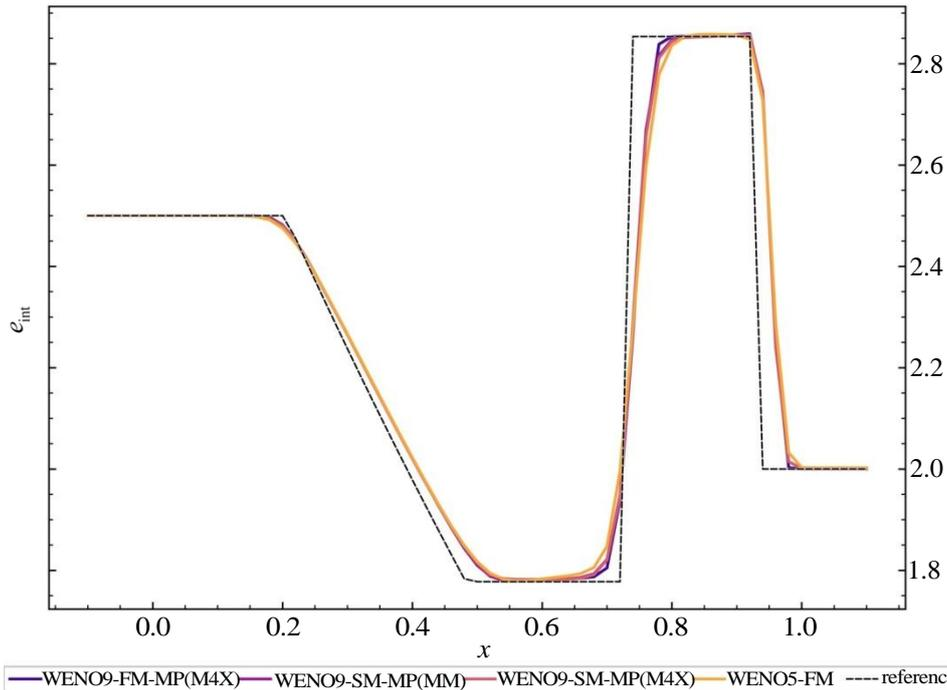
**Рис. 3.** Профиль удельной внутренней энергии теста Сода вдоль  $y = 0.5$  для потока ЛФ, интегрированного SSP RK(10, 4) при CFL=1, с реконструкциями WENO9-SM MP (MM) (фиолетовый цвет), WENO9-SM MP(M4X) (розовый цвет) и WENO5-FM (оранжевый цвет) на  $51 \times 51$  точках. Точное решение проведено пунктиром
