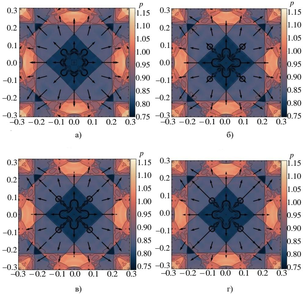
**Рис. 8.** Решения теста имплозии Хуэя и др. [18] имплозии в камере  $[-0.3..0.3] \times [-0.3..0.3]$  ( $401 \times 401$  пространственная сетка) с 12 контурами плотности от 0.45 до 1.05, отображением плотности цветом и поля скоростей стрелками для реконструкций WENO5-FM MP (а), WENO9-FM MP (б), WENO9-S MP (в), WENO9-SM MP (г)
