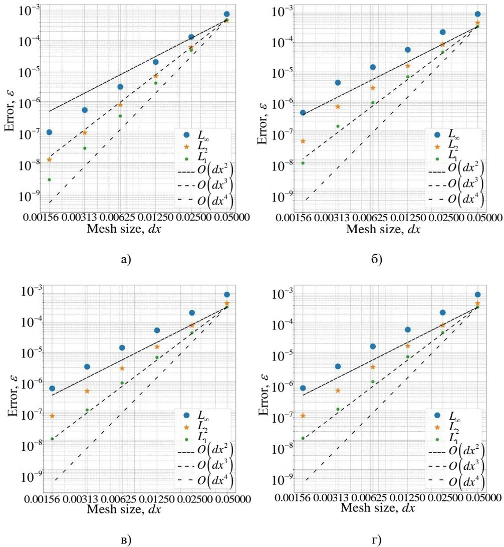
**Рис. 1.** Логарифмический график ошибки численных методов как функции шага сетки  $\Delta x$  для расщеплённого потока Лакса Фридрихса, интегрированного 10-этапным SSP методом Рунге-Кутты 4 порядка с CFL=1, и реконструкциями WENO5-FM (а), WENO9-FM MP (б), WENO9-S MP (в), WENO9-SM MP (г)
