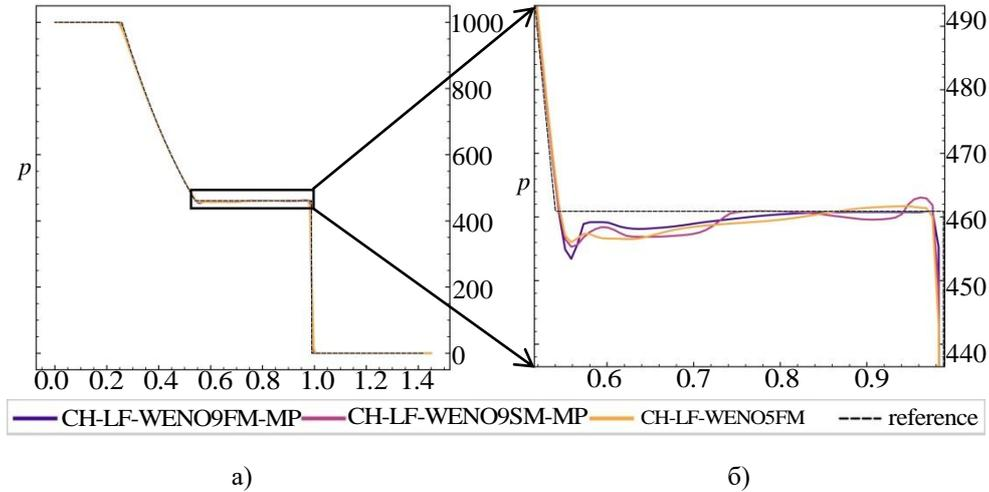
**Рис. 7.** Профили давления вдоль диагонали сильной диагональной ударной волны Торо для реконструкций WENO9-FM MP(M4X) (фиолетовый цвет), WENO9-SM MP(M4X) (розовый цвет) и WENO5-FM (оранжевый цвет) на  $201 \times 201$  точках. Пунктиром проведено точное решение одномерной задачи. На выноске продемонстрирован горизонтальный участок от  $\xi = 0.52$  до  $\xi = 1$
