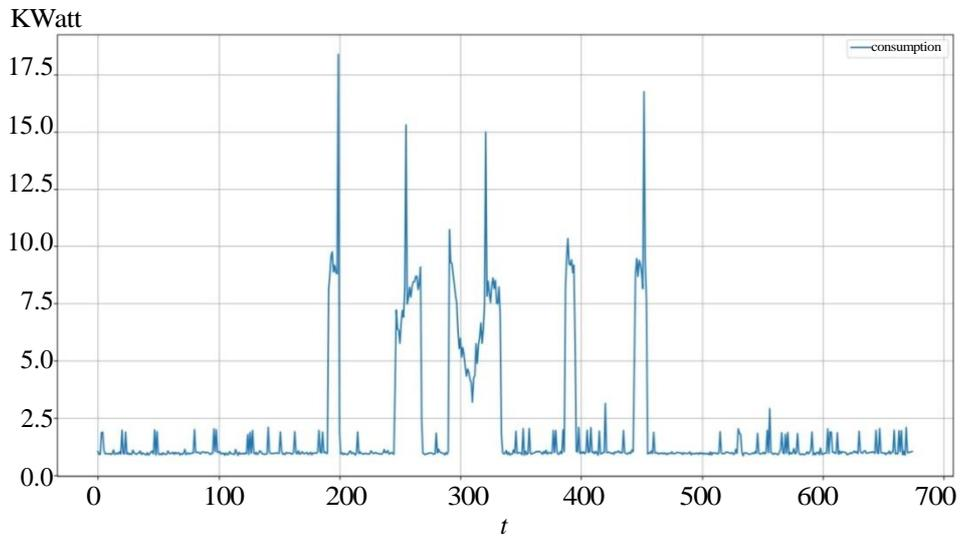
Рис. 5. График энергопотребления машины в течение некоторого времени
