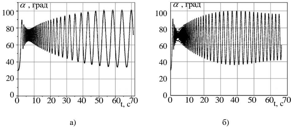
**Рис. 12.** Амплитуда колебаний метеороида  $\alpha$  в зависимости от времени  $t$  при параметрах входа в атмосферу  $V_e = 30$  км/с,  $\alpha_e = 30^\circ$  в случае смещения центра масс от геометрического центра метеороида:
