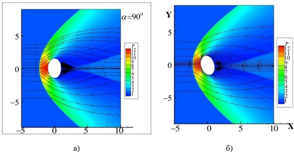
**Рис. 3.** Картины обтекания в аэродинамически устойчивом положении:
