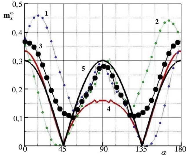
Рис. 6. Модули функции коэффициента демпфирующего момента тангажа, рассчитанные разными методами
