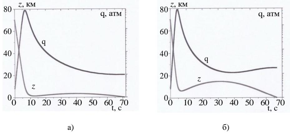
**Рис. 11.** Изменения скоростного напора  $q = \rho V^2/2$  и высоты  $z$  в зависимости от времени полета  $t$  метеороида при входе в атмосферу с параметрами:  $V_e = 30$  км/с,  $\alpha_e = 30^\circ$  в случае смещения центра масс от геометрического центра метеороида:
