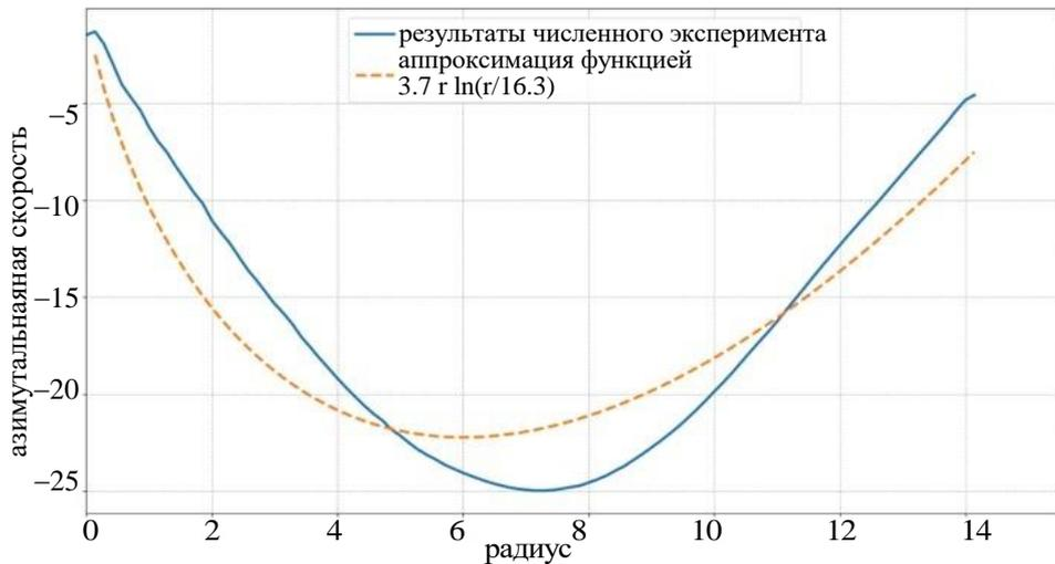
Рис. 4. Усреднённый по углу профиль азимутальной скорости в зависимости от радиуса и его аппроксимация
