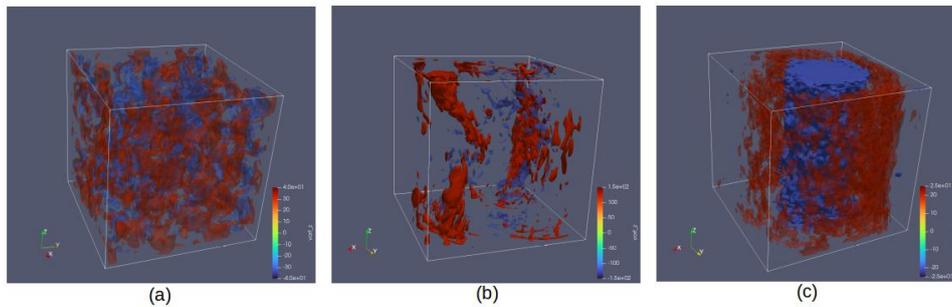
**Рис. 1.** Поверхности завихренности для различных режимов течения: хаотический (а,  $\Omega = 0.16$ ,  $f_0 = 1.6$ ), режим нескольких вихрей (б,  $\Omega = 0.4$ ,  $f_0 = 1.6$ ), режим “циклон-антициклон” (с,  $\Omega = 0.4$ ,  $f_0 = 2.4$ ). Красный цвет поверхности соответствует циклоническому вращению, а синий — антициклоническому
