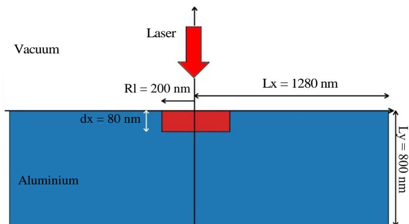
**Рис. 1.** Конфигурация задачи лазерного облучения объёмной алюминиевой мишени.  $L_x$  — полуширина мишени,  $L_y$  — толщина мишени,  $R_l$  — радиус светового пятна,  $d_x$  — глубина первоначального нагрева
