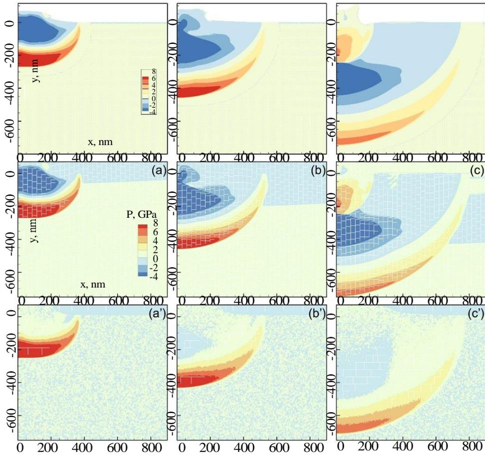
**Рис. 2.** Двумерные диаграммы давления в моменты времени  $t = 28.8$  пс (слева),  $t = 57.6$  пс (центр),  $t = 105.6$  пс (справа). Диаграммы в первом ряду соответствуют расчёту лагранжевым конечно-элементным методом, во втором - методом типа Годунова, в третьем - методом молекулярной динамики
