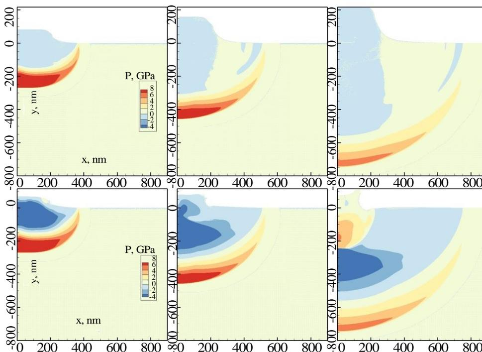
**Рис. 4.** Двумерные диаграммы давления в моменты времени  $t = 28.8$  пс (слева),  $t = 57.6$  пс (центр),  $t = 105.6$  пс (справа). Диаграммы в первом ряду соответствуют расчёту лагранжевым конечно-элементным методом с моделью отрыва, во втором – без модели отрыва
