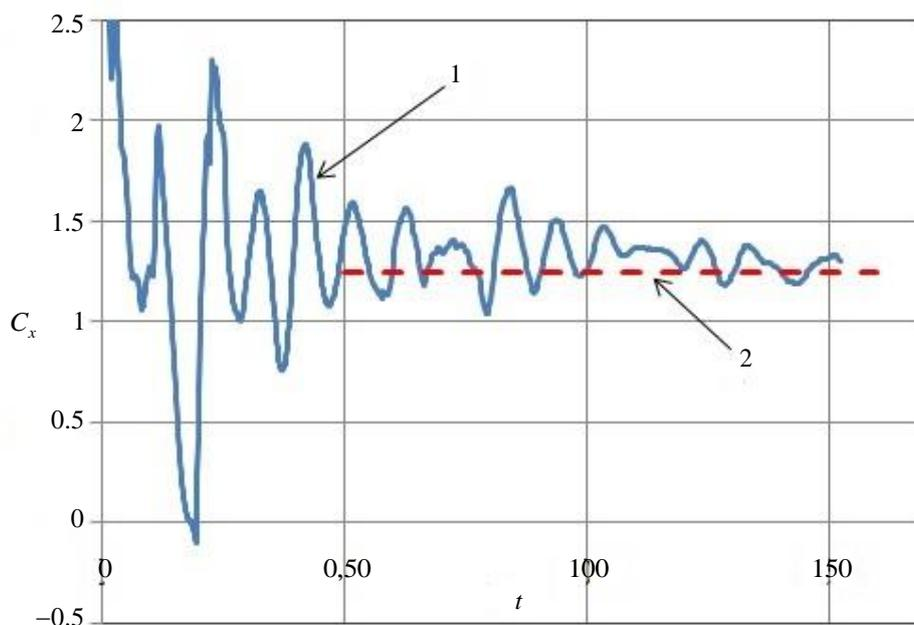
**Рис. 4.** Зависимость  $C_x$  парашюта от времени  $t$ .
