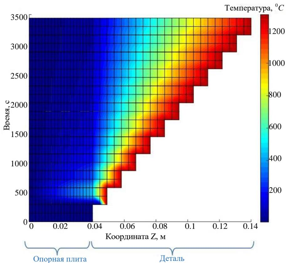
Рис. 2. Распределение температур по оси Z (по направлению выращивания) на основе решения Matlab
