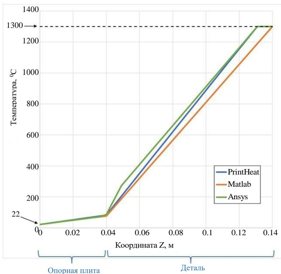
Рис. 4. Сравнение распределения температур в конечный момент времени в Matlab, PrintHeat и Ansys
