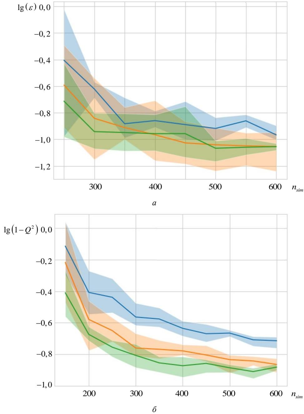
**Рис. 8.** Сравнение эффективности методов планирования экспериментов при моделировании функции Ишигами при увеличении объема выборки  $n_{sim}$  для порядка полиномов  $p = 5$ ;
