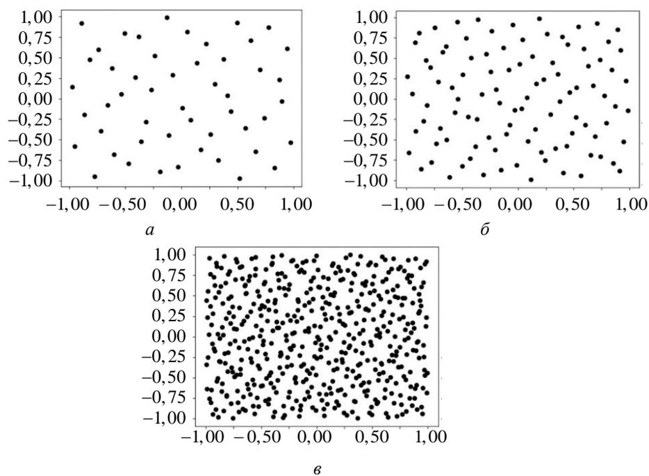
**Рис. 4.** Моделирование методов планирования экспериментов в  $[-1; 1]^2$
