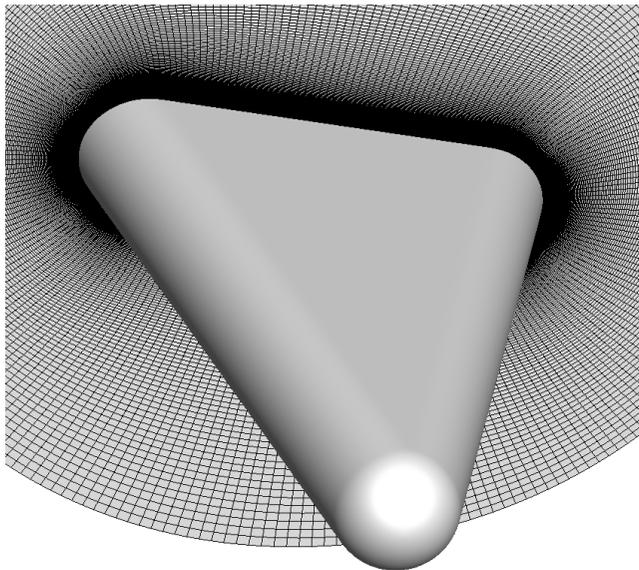
**Рис. 6.** Модель треугольного крыла с затупленными кромками
