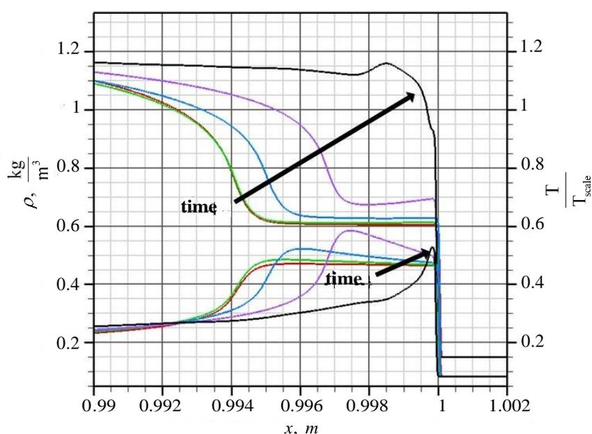
**Рис. 2.** Профили приведенной температуры (сверху) и плотности (снизу) в системе отсчета ЛВ в последовательные моменты времени, интервал времени 620 – 660 мкс (цикл акустической волны), стрелками отмечено направление движения волн с увеличением времени
