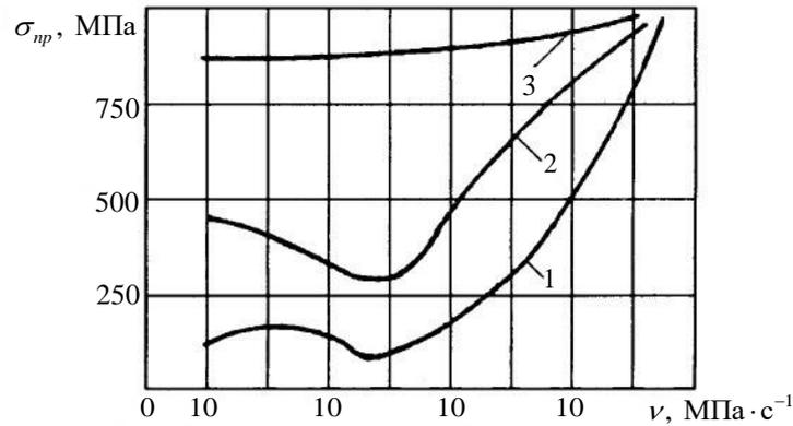
**Рис. 3.** Теоретическая зависимость предела пропорциональности  $\sigma_{np}$  от скорости нагружения  $\nu$  для различных модельных материалов:
