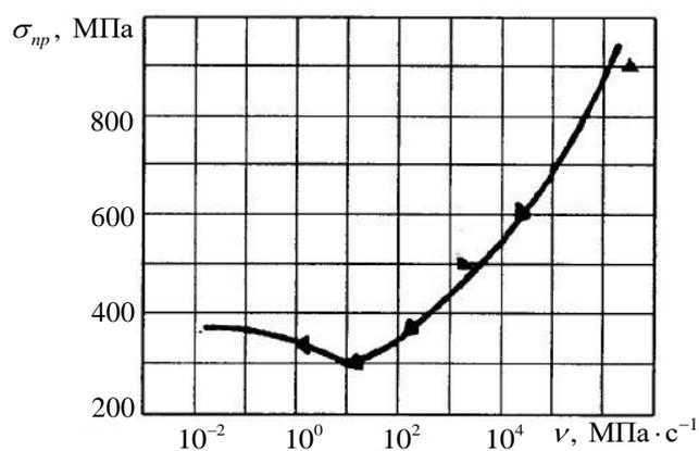
**Рис. 4.** Теоретическая зависимость предела пропорциональности  $\sigma_{np}$  от скорости нагружения  $\nu$  (сплошная линия  $P = 280$  МПа;  $\lambda = 0,4$ ); точки  $\blacktriangle$  — экспериментальные данные для железа Армко
