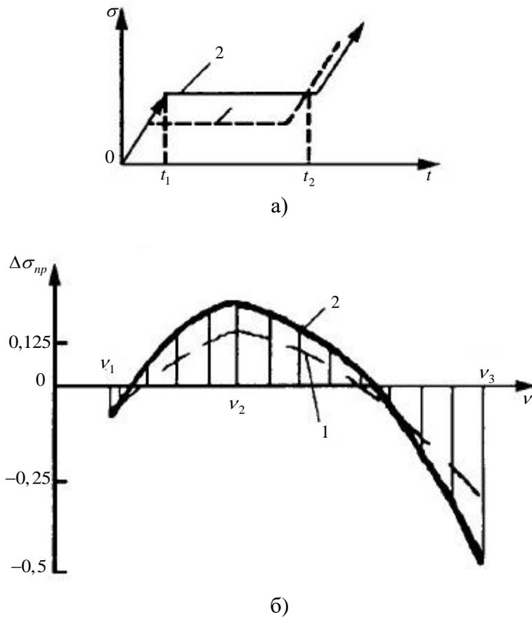
Рис. 6. Результаты теоретического расчета зависимости  $\sigma_{np}^k / \sigma_{np}$  от уровня предварительного нагружения для  $\nu = 2 \cdot 10^7$  МПа·с<sup>-1</sup> при  $P = 400$  МПа,  $\lambda = 0,3$  (1) и  $P = 100$  МПа,  $\lambda = 0,3$  (2)
