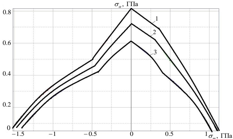
Рис. 4. Диаграммы Гудмана для стали 34CrNiMo6 при циклическом нагружении для значений  $n_s = 10^5$  (1),  $10^6$  (2),  $10^7$  (3), построенные с помощью предложенного «химического» критерия усталостной прочности
