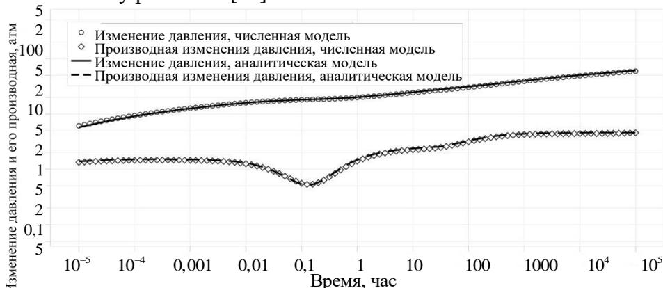
Рис. 2. Изменение давления в многозабойной скважине в пласте с двойной пористостью PSS
