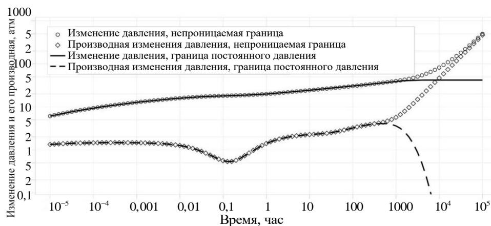
**Рис. 3.** Изменение давления в многозабойной скважине в пласте с двойной пористостью PSS при заданных граничных условиях
