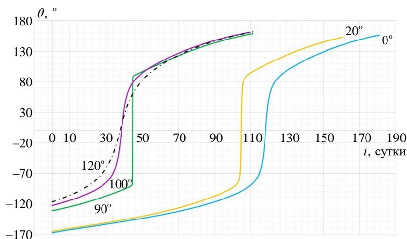
Рис. 5. Изменение оптимального управления в зависимости от угла  $\varphi_0$  при повороте вектора тяги в процессе полета через  $0^\circ$
