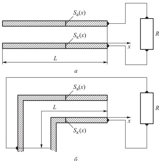
**Рис. 1.** Схемы подсоединения коммутационных проводников к электродам ( $R$  — сопротивление нагрузки):
