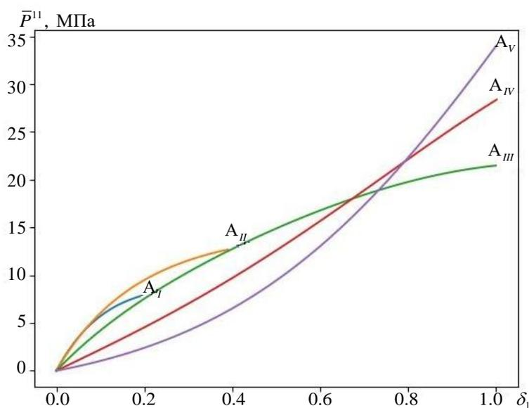
**Рис. 3.** Диаграммы деформирования 3D-армированного КМ при одноосном растяжении для различных моделей  $A_n$ , определяющих соотношений матрицы и волокон, вычисленные с помощью разработанного алгоритма
