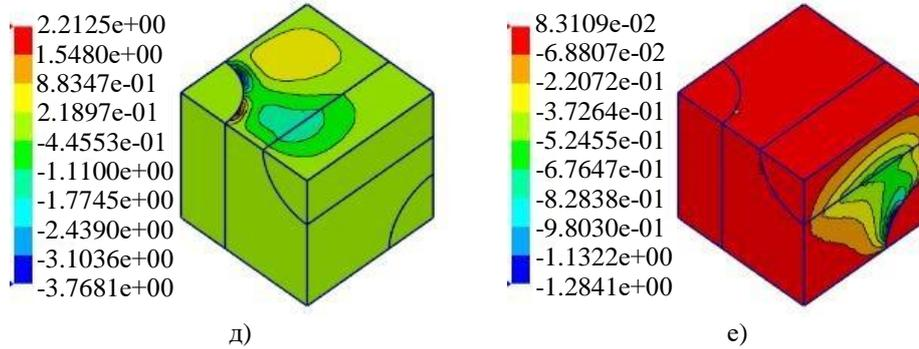
**Рис. 2.** Поля распределения различных компонент  $P^{(0)ij}$  (МПа) тензора напряжений Пиолы-Кирхгофа  $\mathbf{P}^{(0)}$  в ЯП 3D-армированного КМ при растяжении в направлении оси  $O\xi^1$ : а) —  $P^{(0)11}$ , б) —  $P^{(0)22}$ , в) —  $P^{(0)33}$ , г) —  $P^{(0)12}$ , д) —  $P^{(0)13}$ , е) —  $P^{(0)23}$
