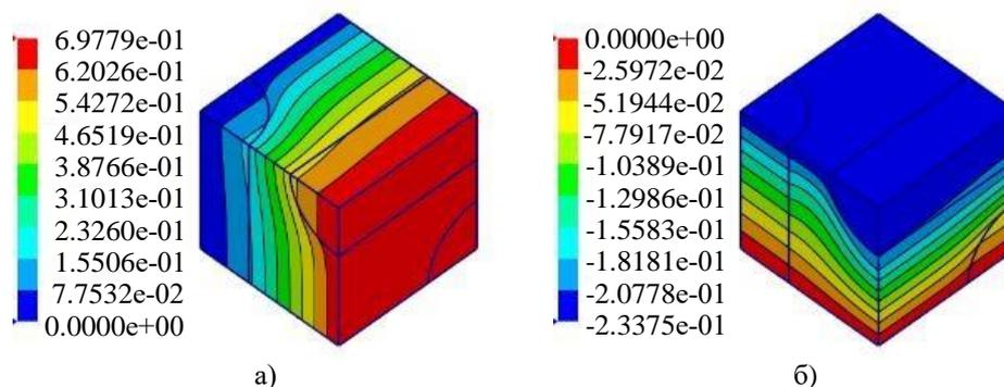
**Рис. 3.** Поля распределения различных компонент  $u^{(1)i}$  вектора перемещений  $\mathbf{u}^{(1)}$  в ЯП 3D-армированного КМ при растяжении в направлении оси  $O\xi^1$ :
