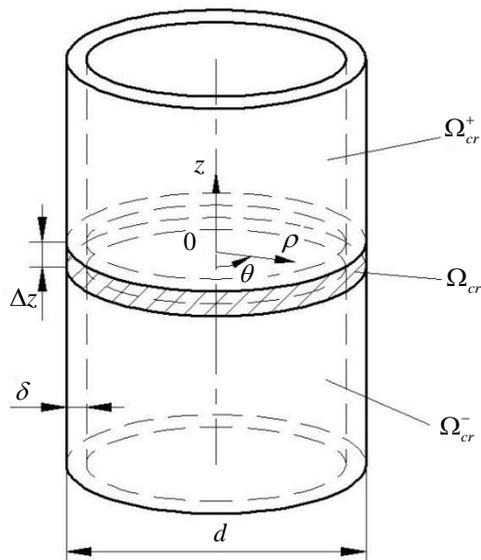
Рис. 2. Модель оболочечной капсулы системы обнаружения трещин
