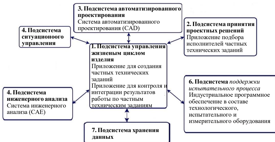
Рис. 2. Структурная схема промышленной цифровой платформы
