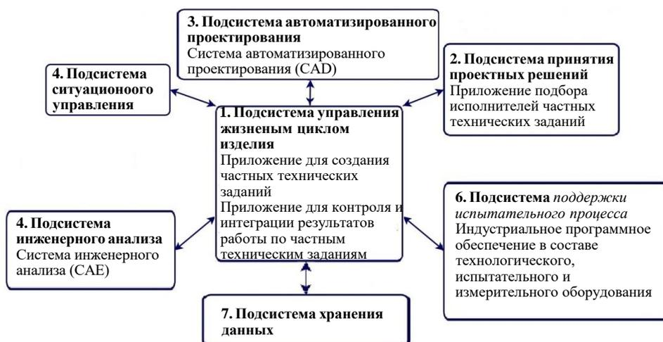
Рис. 2. Структурная схема промышленной цифровой платформы
