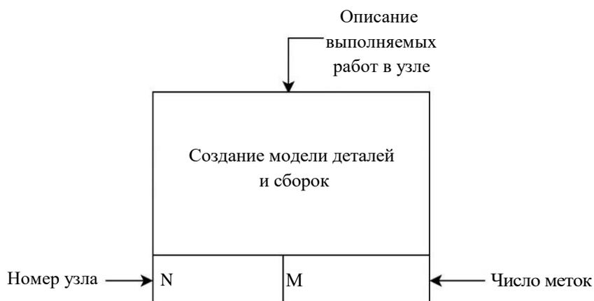
Рис. 3. Пример графического представления узла сети Петри
