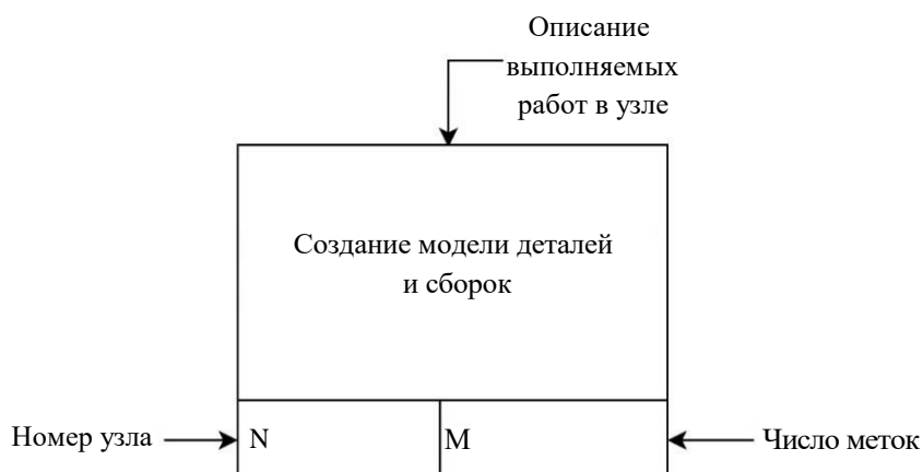
Рис. 3. Пример графического представления узла сети Петри
