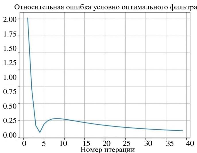
Рис. 2. График относительной ошибки условно оптимального фильтра
