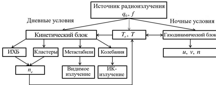
**Рис. 1.** Схема решения пространственно-временной задачи с учетом взаимосвязи кинетической и динамической части. Здесь: ИХБ – атомы, ионы и молекулы, участвующие в ионизационно-химических процессах;  $q_0$  – плотность потока радиоволн у поверхности земли;  $f$  – частота радиоволны;  $\mathbf{u}$ ,  $\mathbf{v}$  – вертикальная и радиальная составляющие скорости;  $n$  – концентрация тяжелых частиц
