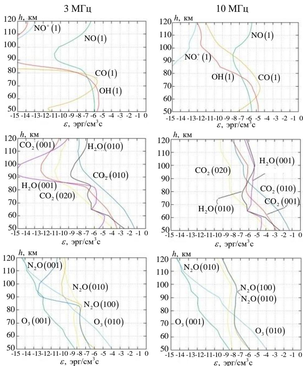
**Рис. 12.** Коэффициенты излучения на момент времени 1 с. Параметры расчета: плотность потока радиоволн  $q_0 = 2.65 \cdot 10^4 \text{ эрг} / \text{см}^2 \text{с}$ , частота радиоволны  $f = 3 \text{ МГц}$ ,  $10 \text{ МГц}$ . Константы скорости возбуждения нижнего метастабильного уровня  $O_2(^1\Delta_g)$  и основного колебательного состояния  $N_2(1)$  снижены на один порядок
