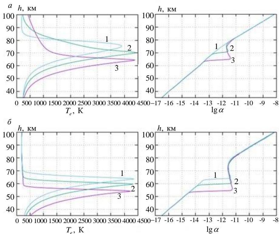
**Рис. 6.** Высотные профили температуры электронов и степени ионизации на момент времени 50 с при плотности потока радиоволн  $2.65 \cdot 10^3$  (а) и  $2.65 \cdot 10^4$  (б) эрг/см<sup>2</sup>с и частоте радиоволны 3 МГц (1), 5 МГц (2) и 10 МГц (3)
