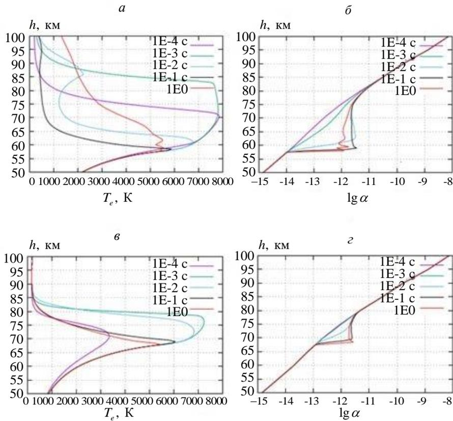
**Рис. 5.** Температура и степень ионизации при учете процессов с высоким энергетическим порогом (ионизации, диссоциации, возбуждения разрешенных электронных переходов) в электронной температуре при частоте  $f = 10$  МГц (а, б), 3 МГц (в, г) и плотности потока радиоволн  $q_0 = 2.65 \cdot 10^4$  эрг/см<sup>2</sup>с
