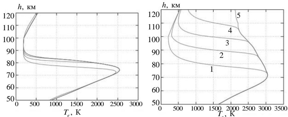
**Рис. 11.** Температура электронов на моменты времени: 1 –  $1\text{E-}4$  с; 2 –  $1\text{E-}3$  с; 3 –  $1\text{E-}2$  с; 4 –  $1\text{E-}1$  с; 5 – 1.0 с. Параметры расчета: плотность потока радиоволн  $q_0 = 2.65 \cdot 10^4$  эрг /  $\text{см}^2\text{с}$ , частота радиоволны  $f = 3$  МГц (а), 10 МГц (б). Константы скорости возбуждения нижнего метастабильного уровня  $\text{O}_2(^1\Delta_g)$  и основного колебательного состояния  $\text{N}_2(1)$  снижены на один порядок
