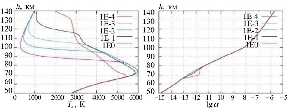
**Рис. 9.** Температура электронов и степень ионизации при плотности потока радиоволн  $q_0 = 2.65 \cdot 10^5$  эрг / см<sup>2</sup>с и частоте  $f = 10$  МГц при оценке константы скорости сверху
