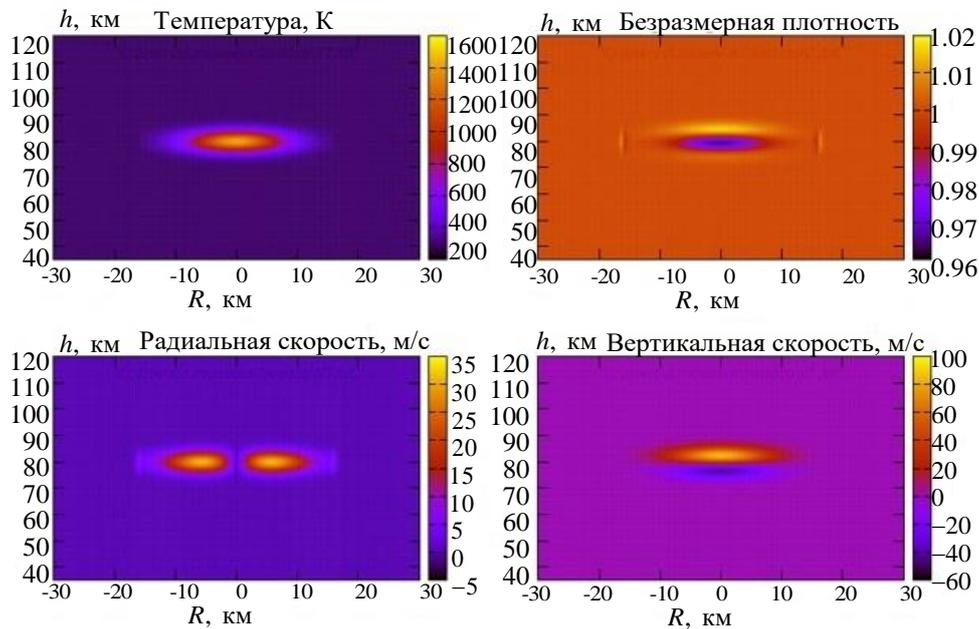
**Рис. 13.** Параметры возмущенной области (температура, плотность, составляющие скорости). Время расчета 3 с, шаг по пространству  $dr = dz = 0.01$  (сетка равномерная), шаг по времени  $\tau = 0.001$ ,  $\alpha = 0.1$ ,  $S_{\max} = 15$ ,  $\tau_1 = 0.02$ ,  $\tau_2 = 0.22$
