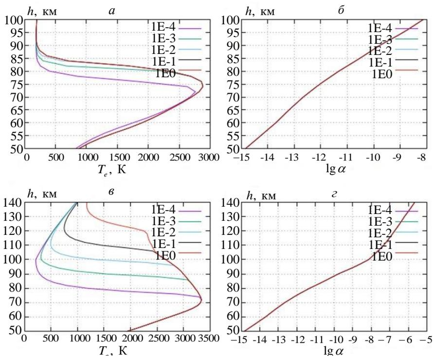
**Рис. 7.** Температура и степень ионизации при частоте  $f=3$  МГц (а), 10 МГц (б) и плотности потока радиоволн  $q_0 = 2,65 \cdot 10^4$  эрг / см<sup>2</sup>с без учета влияния потерь на возбуждение метастабильных состояний
