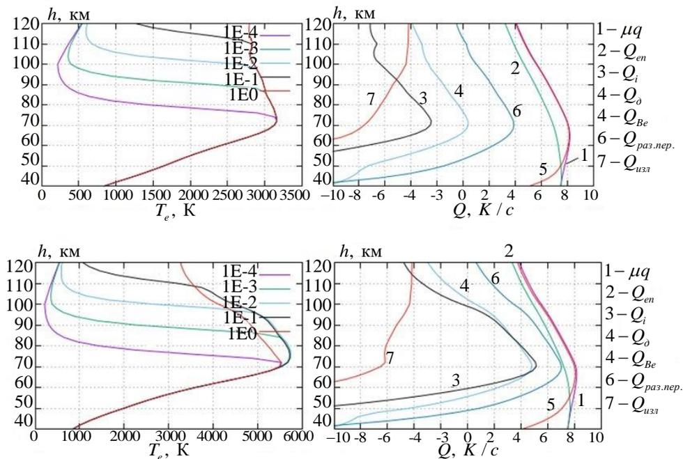
**Рис. 10.** Распределения температуры электронов ( $T_e$ ) и правых частей ур. (4) при плотности потока радиоизлучения  $q_0 = 2.65 \cdot 10^4 \text{ эрг} / \text{см}^2 \text{с}$  и частоте  $f = 10 \text{ МГц}$  при константе скорости возбуждения метастабильного состояния  $O_2(^1\Delta_g)$ , отличающейся на порядок (а) и на два порядка (б)
