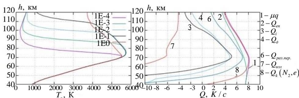
**Рис. 8.** Температура и правые части ур. (4) при частоте  $f = 10$  МГц и плотности потока радиоволн  $q_0 = 2.65 \cdot 10^4$  эрг / см<sup>2</sup>с без учета влияния потерь на возбуждение метастабильных состояний при уменьшении константы скорости возбуждения колебательных состояний на один порядок
