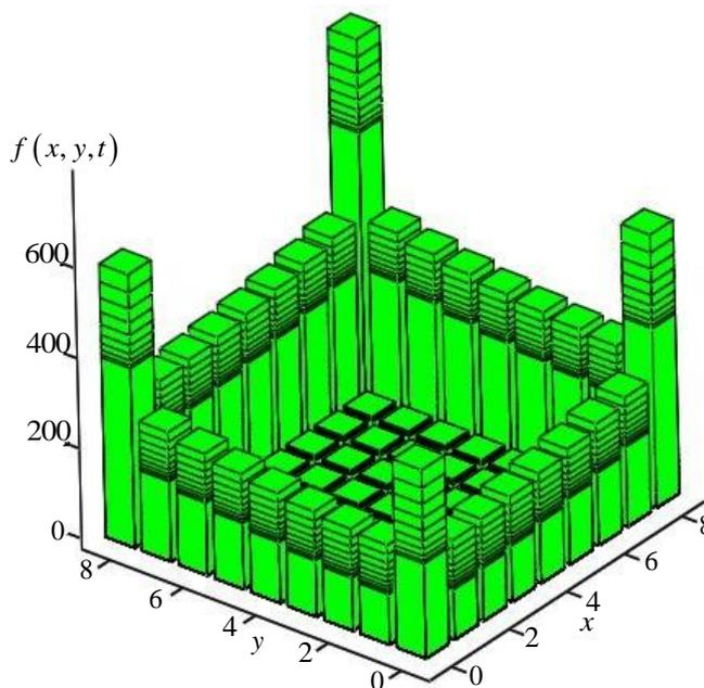
Рис. 2. Оптимальное расположение источников тепла  $f(x, y, t)$
