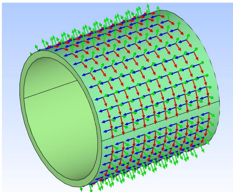
Рис. 6. Модель композитного цилиндра с заданными локальными осями криволинейной анизотропии в ПК SMCM
