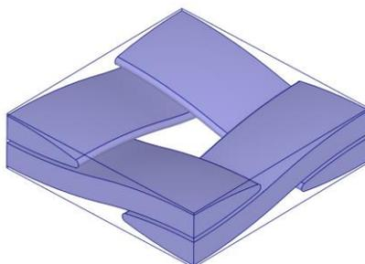
**Рис. 2.** Ячейка периодичности тканевого композита полотняного плетения (матрица не показана)
