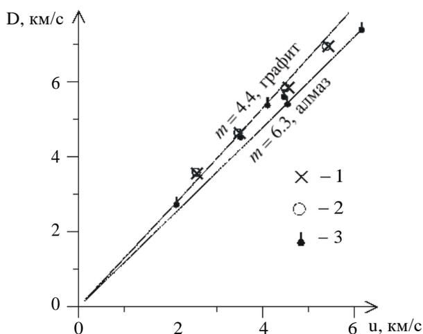
**Рис. 5.** Ударные адиабаты алмаза и графита в координатах массовая скорость за фронтом ударной волны – скорость фронта ударной волны: сплошные кривые – расчетные адиабаты; эксперименты: алмаз 1 – [14]  $m = 6.277$ ; 2 – [15]  $m = 5.754$ ; графит 3 – [13]  $m = 4.861$
