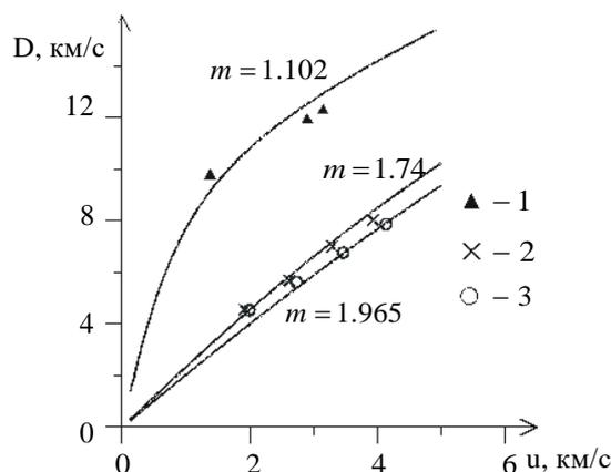
**Рис. 3.** Ударные адиабаты пористого алмаза в координатах массовая скорость за фронтом ударной волны – скорость фронта ударной волны: сплошная кривая – расчетная адиабата; эксперименты 1 – [13]  $m = 1.102$ ; 2 – [14]  $m = 1.738$ ; 3 – [14]  $m = 1.961$
