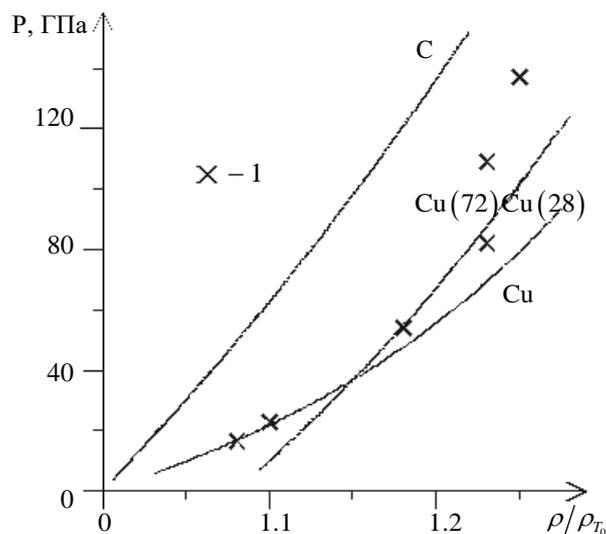
**Рис. 8.** Ударные адиабаты алмаза, меди и смеси медь-алмаз в координатах относительная плотность за фронтом ударной волны – давление за фронтом ударной волны: обозначения как на рис. 7
