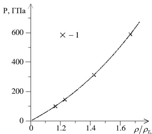
Рис. 2. Ударные адиабаты сплошного алмаза в координатах относительная плотность за фронтом ударной волны — давление за фронтом ударной волны: обозначения как на рис. 3
