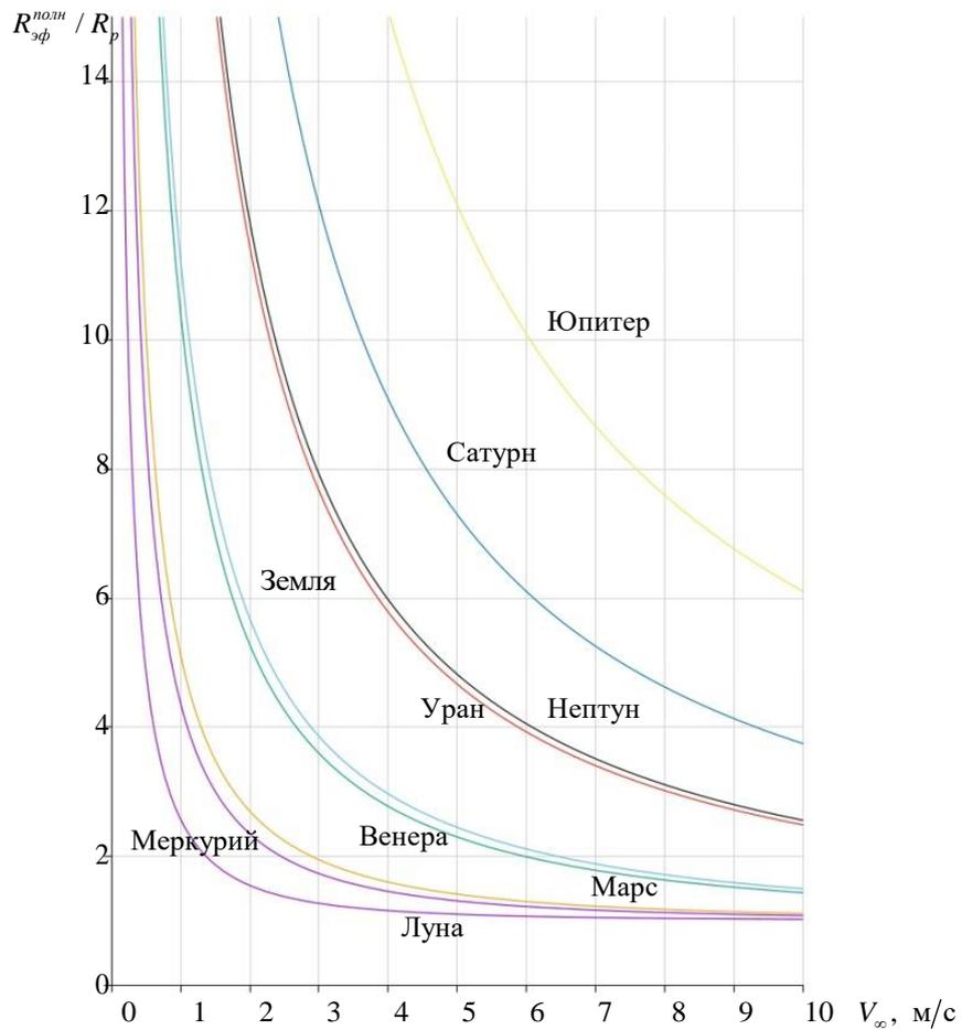
Рис. 3. Зависимости от асимптотической скорости соотношения полного эффективного  $R_{эф}^{полн}$  и истинного радиусов  $R_p$  для небесных тел Солнечной системы
