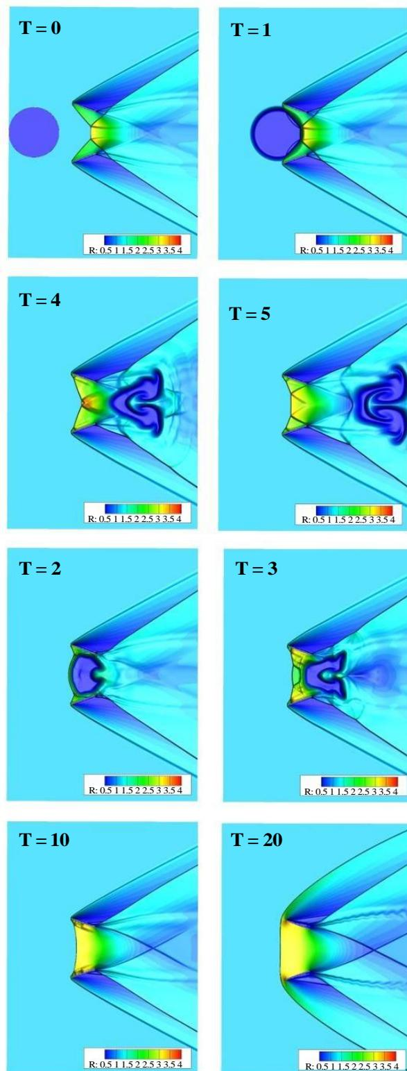
Рис. 6. Течение при  $M = 2.3$ , неоднородность по плотности 0.2
