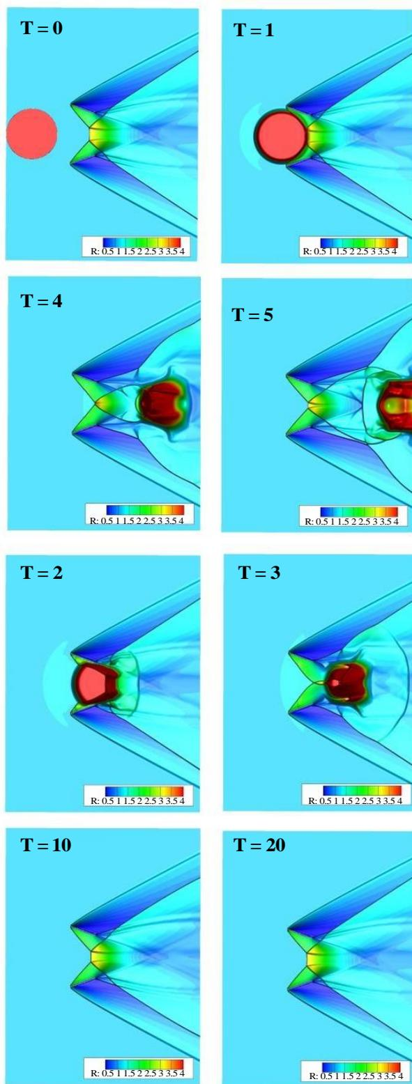
Рис. 7. Течение при  $M = 2.3$ , неоднородность по плотности 5.0
