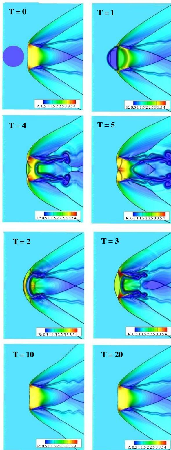
Рис. 8. Течение при  $M = 2.5$ , неоднородность по плотности 0.2
