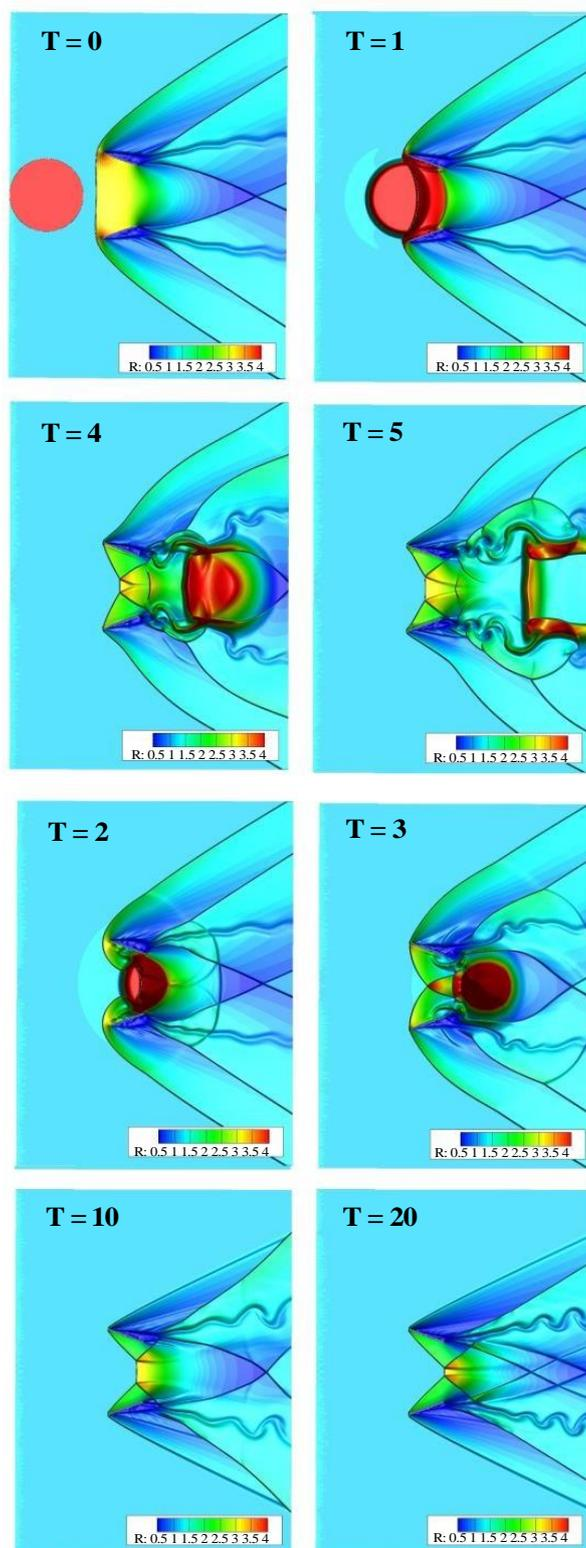
Рис. 9. Течение при  $M = 2.5$ , неоднородность по плотности 5.0
