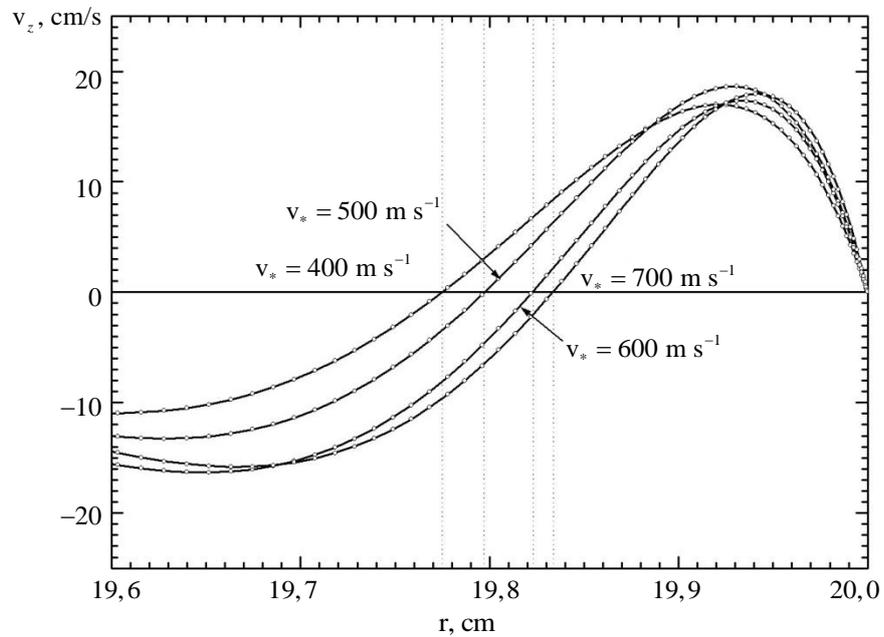
**Рис. 2.** Графики зависимостей аксиальных скоростей от радиуса на полувысоте цилиндра  $v_z(r, z = z_{\max} / 2)$  для разных скоростей вращения  $v_* = 400, 500, 600, 700 \text{ см с}^{-1}$ . Вертикальные линии (точка инверсии) проведены для значений  $r = 19.775, 19.797, 19.823, 19.834 \text{ см}$
