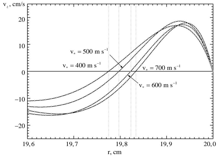
**Рис. 2.** Графики зависимостей аксиальных скоростей от радиуса на полувысоте цилиндра  $v_z(r, z = z_{\max} / 2)$  для разных скоростей вращения  $v_* = 400, 500, 600, 700 \text{ см с}^{-1}$ . Вертикальные линии (точка инверсии) проведены для значений  $r = 19.775, 19.797, 19.823, 19.834 \text{ см}$
