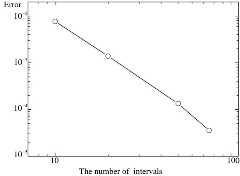
**Рис. 1.** Зависимость относительной ошибки решения в Эвклидовой норме всех независимых переменных во всех узлах сетки от числа интервалов  $i_{\max} = k_{\max}$  в момент  $t = 0.01$  с для тестового двумерного решения
