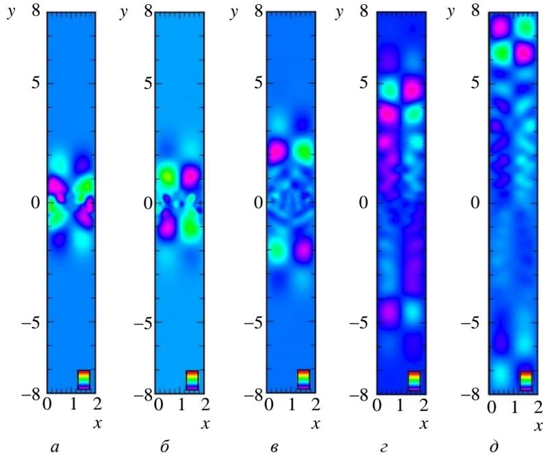
**Рис. 8.** Динамика поля функции тока при коллапсе цепочки пятен для параметров:  $R_0 = 0,6$ ;  $\mu/\rho_0 = 0,01 \text{ см}^2/\text{с}$ ;  $k_s = 1,41 \cdot 10^{-5} \text{ см}^2/\text{с}$ ;  $Sc = 709,2$ ;  $Re = 3162$ ;  $Fr = 1$ :
