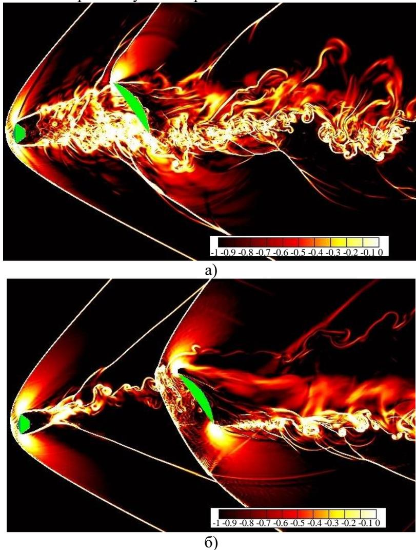
Рис 7. Структура потока около находящегося под углом атаки спускаемого аппарата при  $\alpha = 10^\circ$  и несоосном расположении в его следе парашюта при различных расстояниях между ними. а) —  $\alpha = L_p = 12$ ; б) —  $L_p = 18$
