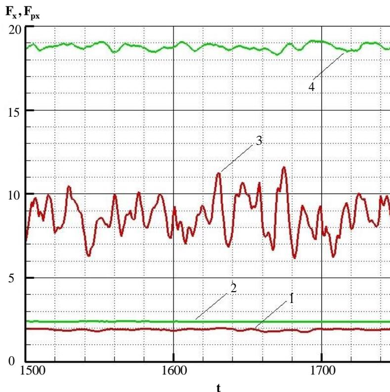
**Рис 6.** Зависимости во времени при  $\alpha=10^\circ$  действующей на аппарат продольной аэродинамической силы  $F_x$  (кривые — 1,2) и действующей на парашют аэродинамической силы  $F_{px}$  (кривые — 3,4) при различных расстояниях между аппаратом и парашютом.
