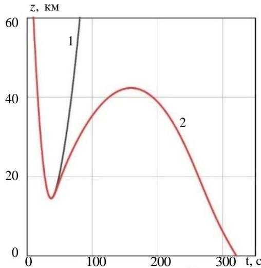
**Рис 5.** Зависимость высоты полета  $z$  от времени  $t$  железного астероида для угла входа в атмосферу  $\theta_e = 9^\circ$  при  $\sigma^* = 10^8$  Н/м<sup>2</sup>: 1 – без учета фрагментации; 2 – с учетом фрагментации, показатель степени неоднородности материала  $\alpha = 0.25$
