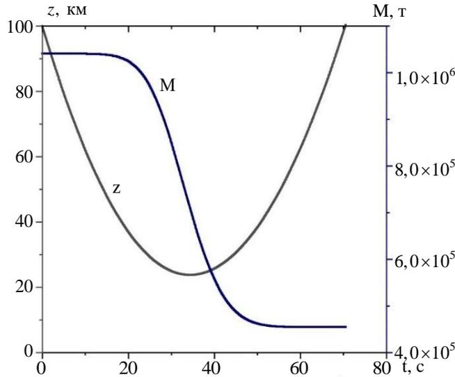
**Рис. 6.** Зависимость высоты полета  $z$  и массы  $M$  от времени  $t$  железного астероида для угла входа в атмосферу  $\theta_e = 8.5^\circ$  и при  $\sigma^* = 10^8$  Н/м<sup>2</sup>
