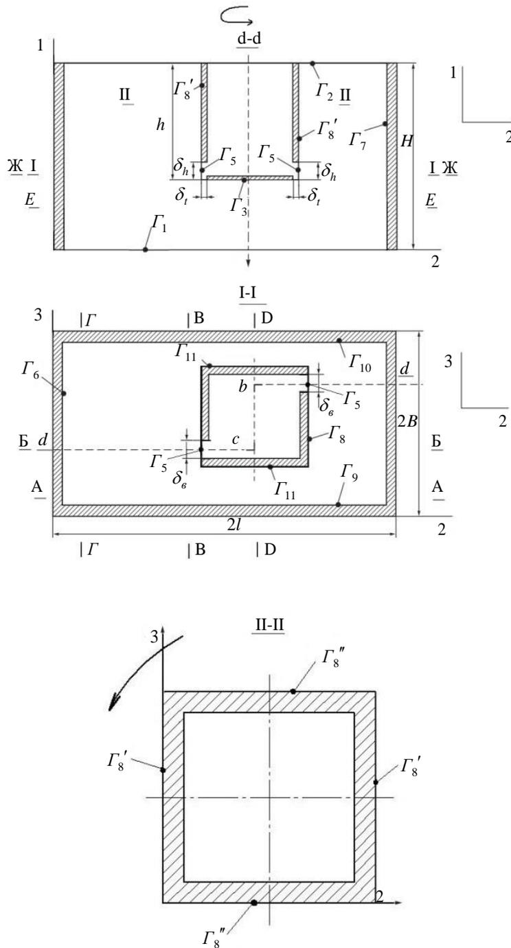
Рис 3. Формализованная расчетная схема процесса разливки металла в кристаллизатор
