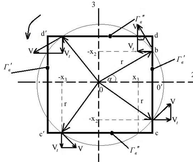
Рис 2. Схема вращения погружного стакана
