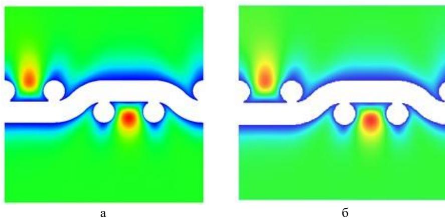
Рис. 4. Поля модуля вектора скорости жидкости для 3D-моделей рис. 1б в плоскости  $Oyz$  расчётной области для  $Re_{Ar} = 0,4$ , полученные: а – методом SIMPLE, б – методом LBM
