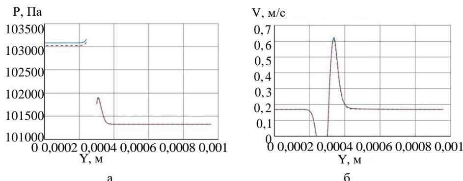
**Рис. 6.** Графики зависимости давления (а) и модуля вектора скорости (б) жидкости от координаты  $y$  в плоскости  $Oyz$  расчётной области для 3D-моделей рис. 1б (синяя сплошная линия) и 1в (красная пунктирная линия) при  $Re_{Ar} = 0,4$ , полученные методом SIMPLE
